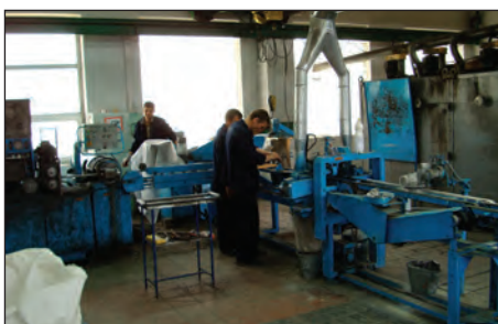
Рис. 1. Линия изготовления электродов на прессе ПЭО1000
