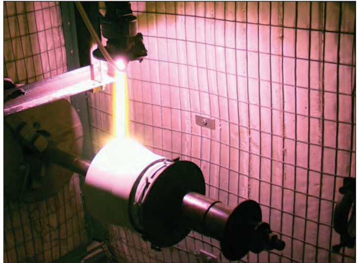
Рис. 2. Напыление термобарьерного покрытия на деталь реактора пиролиза
