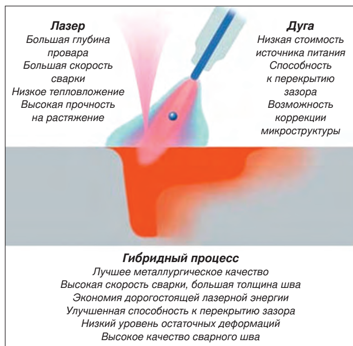
Рис. 4. Сочетание процессов лазерной и дуговой сварки
