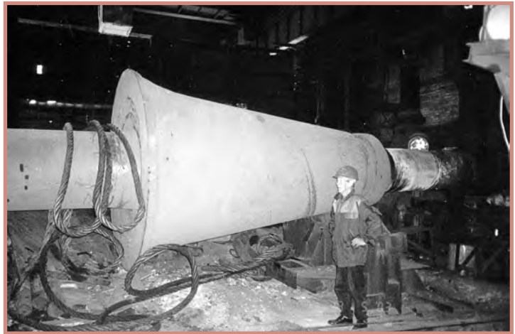
Рис. 3. Дробящий конус, установленный в положение для наплавки цилиндрической поверхности
