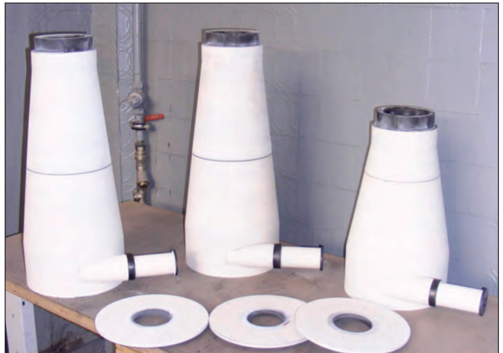
Рис. 3. Рабочая стенка реактора пиролиза с напыленным термобарьерным покрытием
