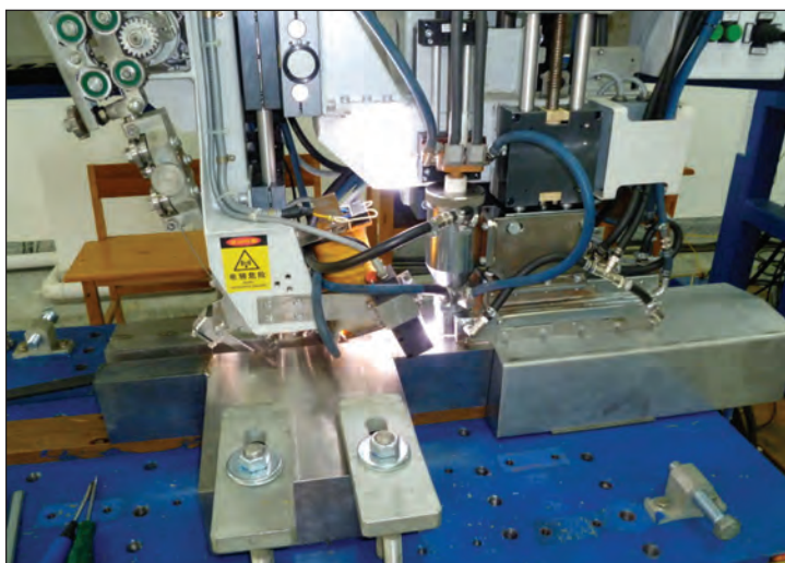
Рис. 2. Сварка образца толщиной 110 мм
