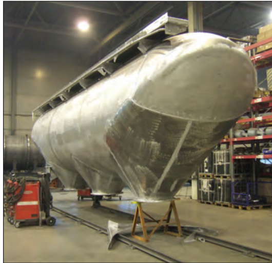
Рис. 6. Корпус цементовоза с фрагментом воронки, изготовленной с помощью сварки трением с перемещением
