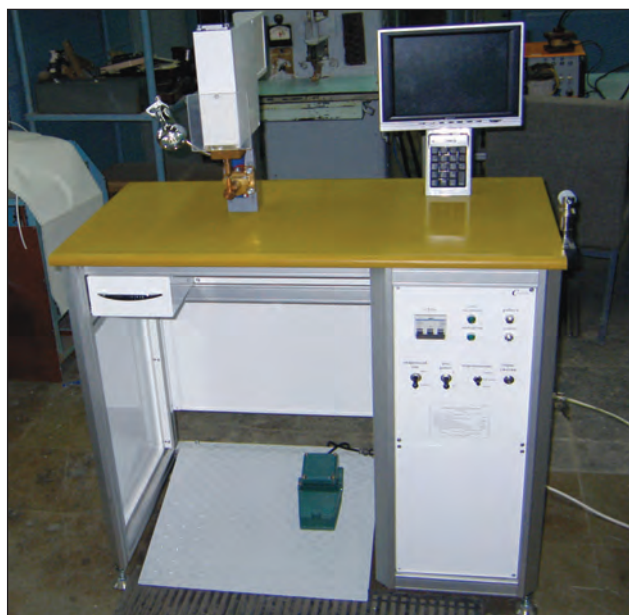
Рис. 1. Машина МТЧ–5.05 для контактной сварки с электроприводом сжатия
