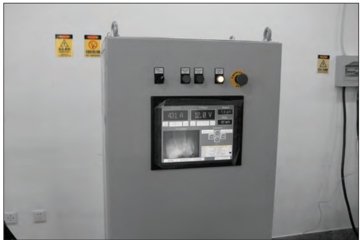
Рис. 4. Шкаф системы управления с сенсорным дисплеем
