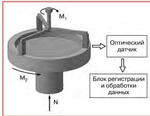
Рис. 1. Принципиальная схема трибологических испытаний
