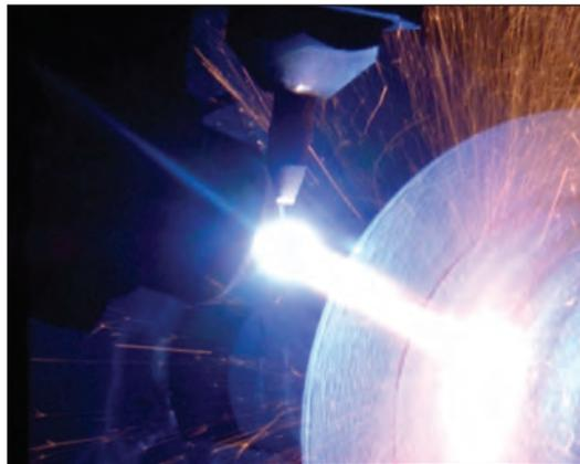
Рис. 3. Плазменно-дуговая металлизация шейки оси
