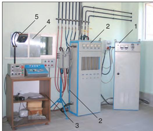
Рис. 3. Оборудование для импульсно-плазменного упрочнения инструмента
