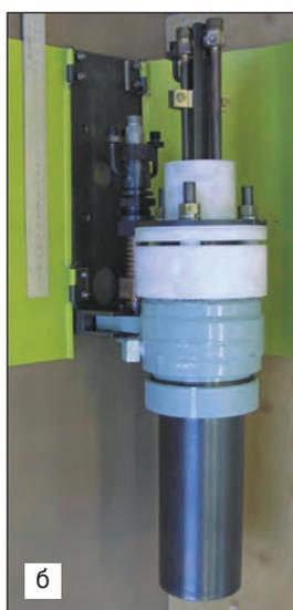
Рис. 1. Импульсный плазмотрон: а — схема; б — внешний вид
