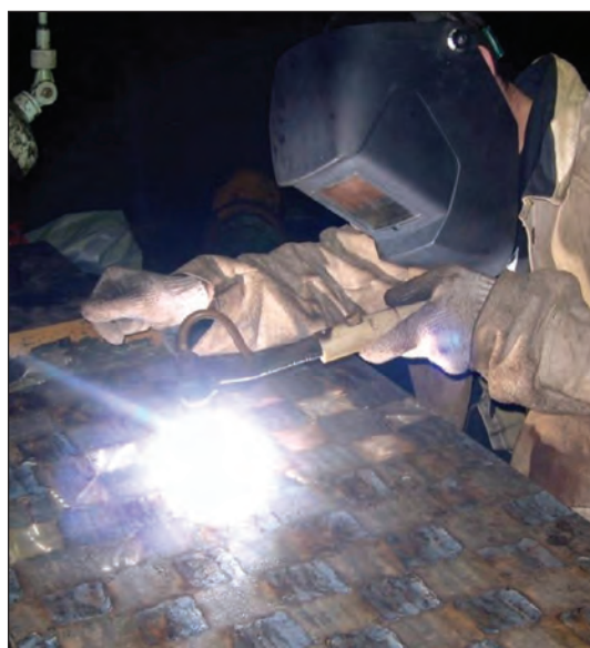
Плазменная закалка установкой УДГЗ-200 лицевой плиты для прокатной клети
