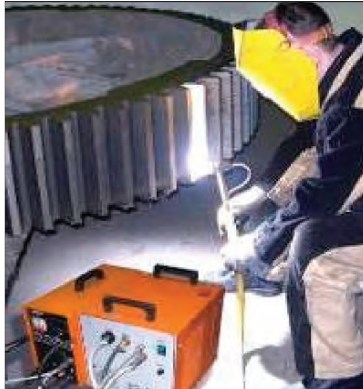
Закалка установкой УДГЗ-200 зубчатого колеса
