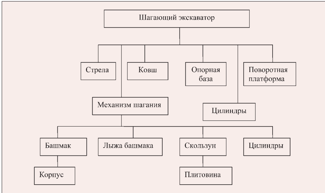
Рис. 2. Декомпозиция базовых деталей на примере шагающего экскаватора
