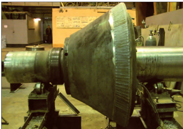
Плазменная закалка конуса дробилки Сандвик
