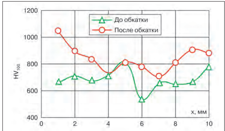
Рис. 2. Микротвердость поверхности напыленного покрытия из проволоки 150Х8Т2 до обкатки и после нее
