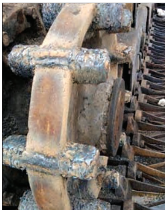
Рис. 1. Внешний вид восстановленной ведущей звездочки крана КС8165
