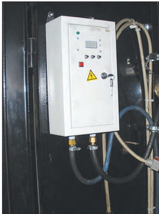
Рис. 2. Блок поджига и сканирования дуги, смонтированный на суппорте станка
