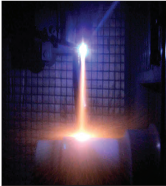
Рис. 3. Плазменно-дуговое напыление износостойких покрытий на шейку оси колесной пары на линии PLAZER 30PL-W
