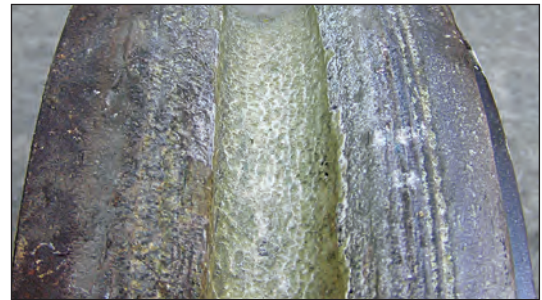
Рис. 2. Характерный износ поверхности третьего валка
