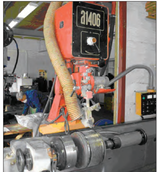
Рис. 3. Установка наплавки валков центрифуг
