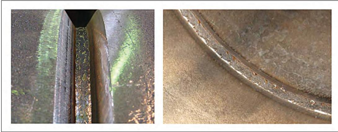
Сварка неповоротного стыка трубопровода с помощью функции pipeSolution®
