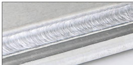
Импульсная сварка AlMg5
