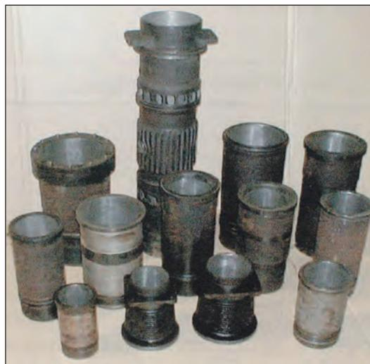
Рис. 6. Цилиндрические втулки тяжело нагруженных дизелей с плазменным покрытием
