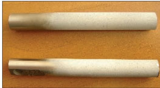
Рис. 4. Внешний вид деталей с керамическим плазменным покрытием  $\text{ZrO}_2\text{-7\%Y}_2\text{O}_3$ , нанесенным по технологии PLAZER®
