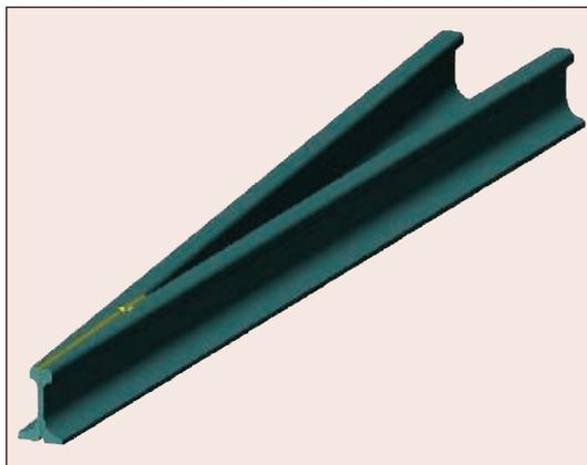
Рис. 2. Внешний вид сварного шва со стороны головки рельса
