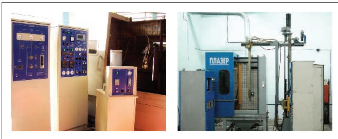
Рис. 2. Наружное (а) и внутреннее (б) напыление
