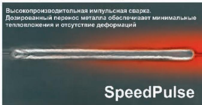
Высокопроизводительная импульсная сварка. Дозированный перенос металла обеспечивает минимальные тепловложения и отсутствие деформаций
