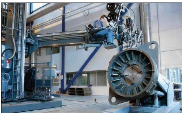
Установка для сварки кольцевых швов PEMA
