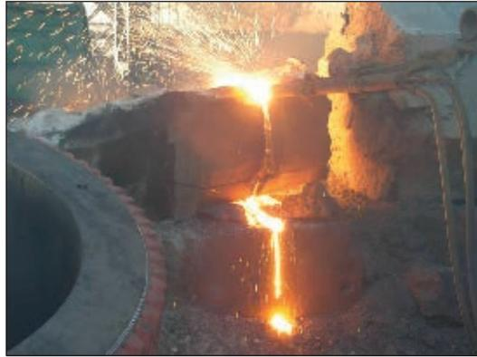
Рис. 7. Поковка толщиной 600 мм группы металлоотходов Б57 (20X12ВНМФ). Резка мундштуком №1
