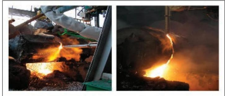
Рис. 2. Разделка крупногабаритного металлолома резаком РГКМ-3 с мундштуками внешнего смешивания на эстакаде копрового цеха
