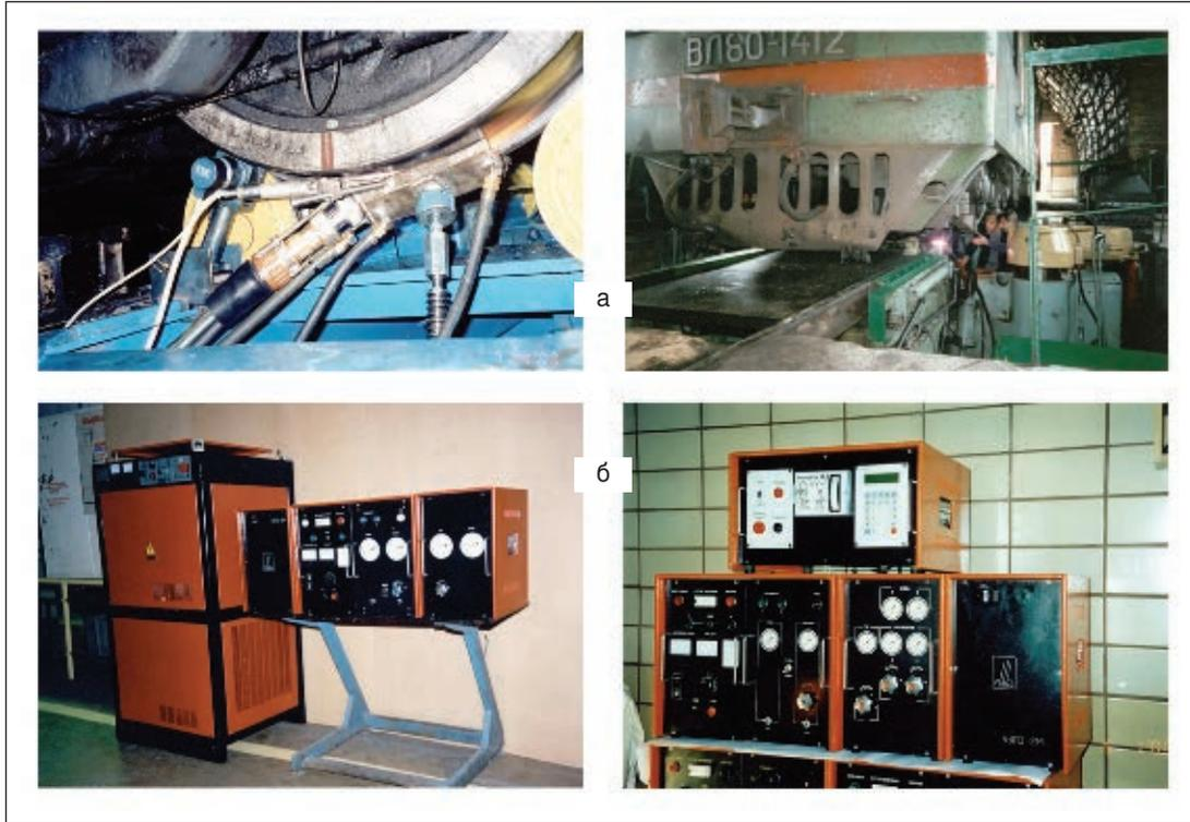
Рис. 1. Установка высокопроизводительной поверхностной закалки УВПЗ-2М: а — процесс напыления; б — модули установки
