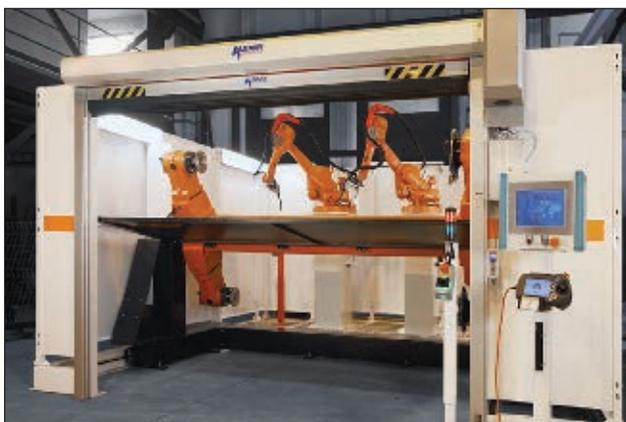
Роботизированная сварочная ячейка АВВ
