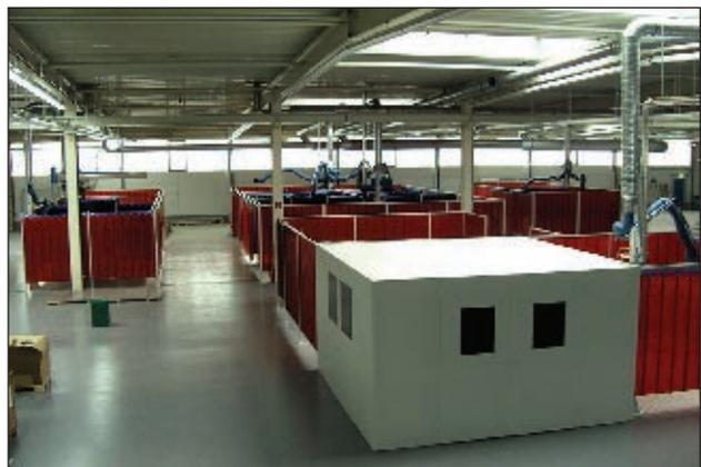
Перегородки и ограждения со сварочными шторами
