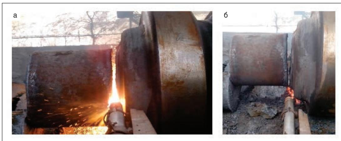
Рис. 5. Резка шейки прокатного вала диаметром 600 мм, сталь 60ХН, резаком РГКМ-5, мундштук №3: а — процесс резки; б — полость реза
