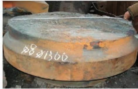
Рис. 8. Резка прокатного валка диаметром 1300 мм, сталь 60ХН резакотом РГКМ-5, мундштук №2
