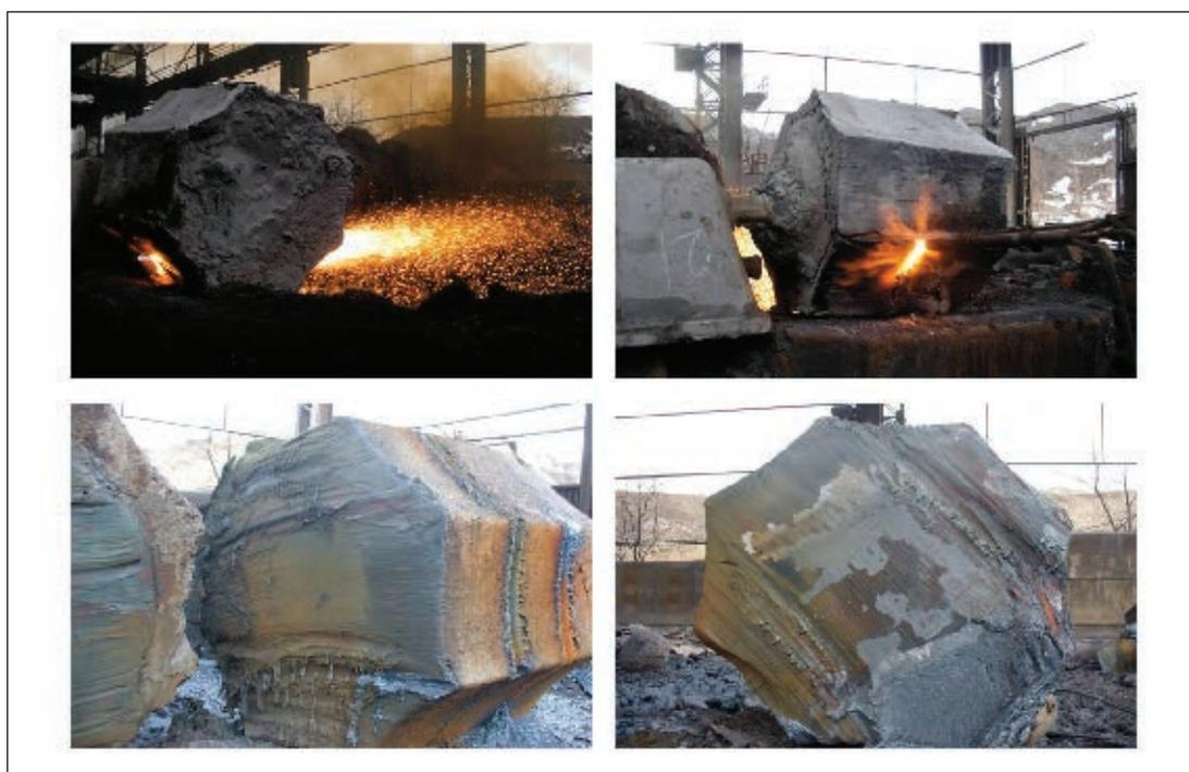
щью подъемного крана образовавшиеся пластины отбили от тела «козла», после чего его вернули к МГР и дорезали остаток (рис. 11). Поскольку температура воспламенения чугуна выше, чем температура плавления, и воспламенять приходится жидкий металл, то при врезке (начале резки) необходимо хорошо прогреть место врезания, затем постоянно поддерживать высокую температуру фронтальной части полости реза. Характеристики факела мундштука №2 соответствуют этим требованиям.
