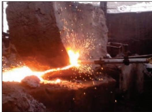
Рис. 9. Резка скрапины по толщине 800 мм мундштуком №2
