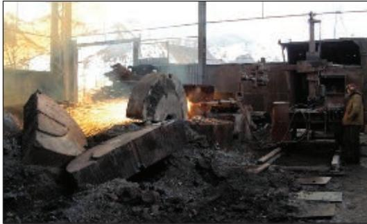
Рис. 6. Продольная резка шайбы, сталь 30X13, толщиной 500 мм
