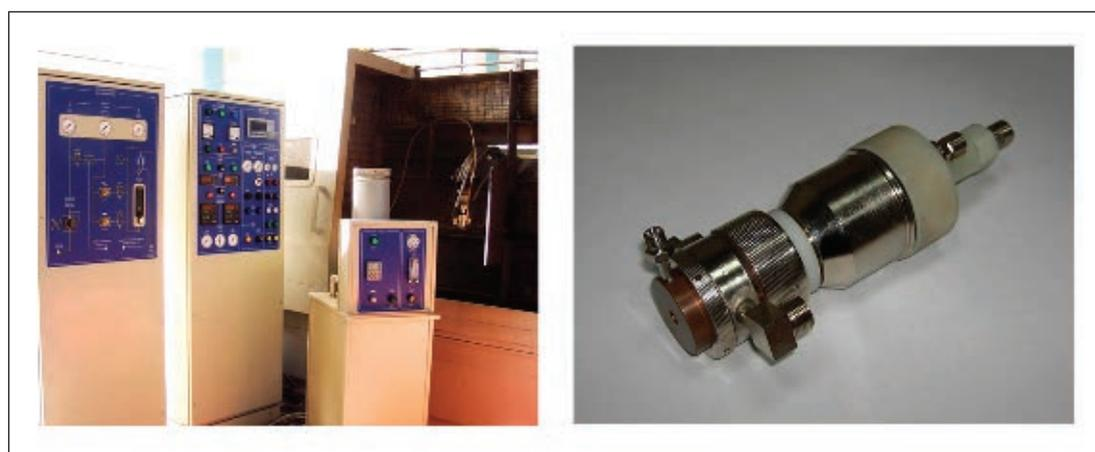
Рис. 3. Установка плазменного напыления PLAZER 160 со сверхзвуковым плазматроном мощностью 160 кВт
