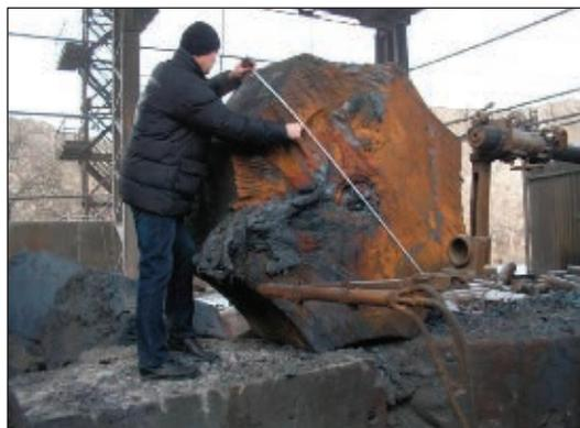
Рис. 10. Резка слитка диаметром 1700 мм мундштуком №2
