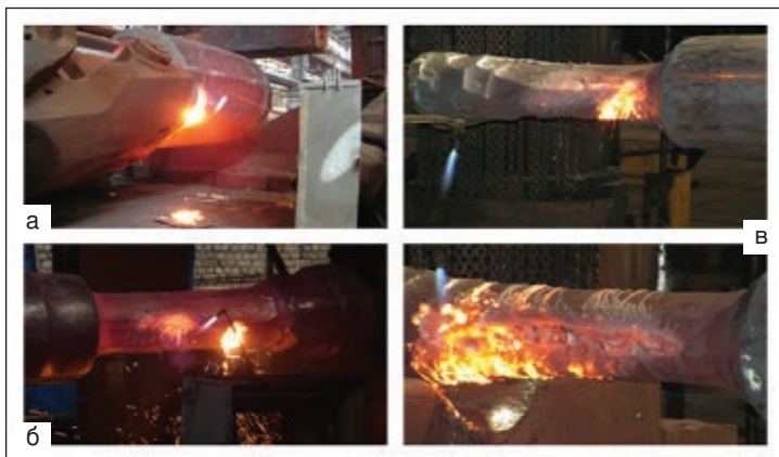
Рис. 4. Дефектные места на поковках после выплавки. Виды дефектов: а — зажим; б — плены; в — трещины
