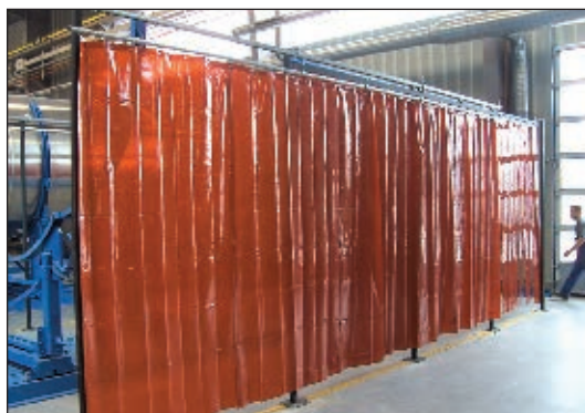
Сварочные перегородки со шторами
