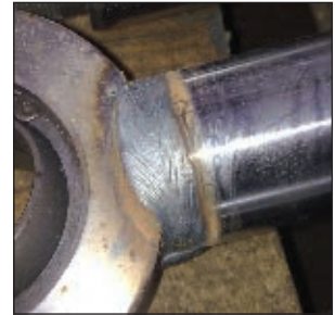
Рис. 2. Кольцевой шов соединения «проушины» со «штоком» гидроцилиндра
