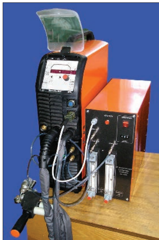
Рис. 1. Внешний вид установки МПН-004 для микроплазменного напыления
