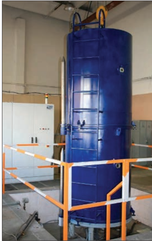
Рис. 1. Установка УА-63-950/3000 с изменяемой геометрией рабочей камеры
