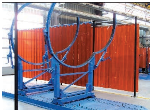
Сварочные перегородки со шторами и жалюзиными занавесками
