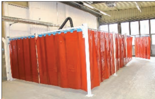
Рабочие зоны для сварочных работ
