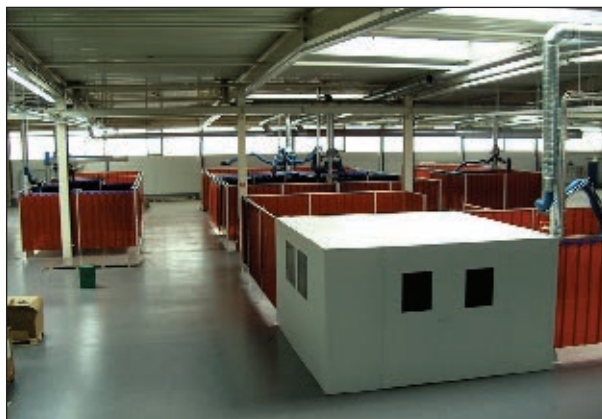
Рабочие зоны для сварочных работ
