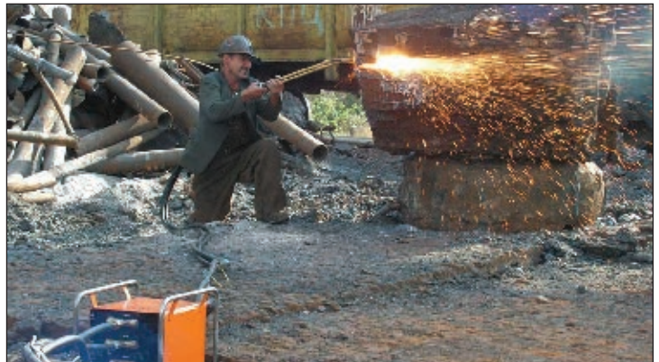
Рис. 7. Резка стального «козла» полуавтоматом УРВД. Резак РПКЗ-02 с наконечником для резки концов поковок и удаления наплывов
