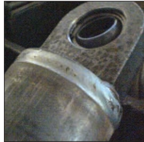
Рис. 1. Кольцевой шов соединения «корпуса» с «крышкой» гидроцилиндра
