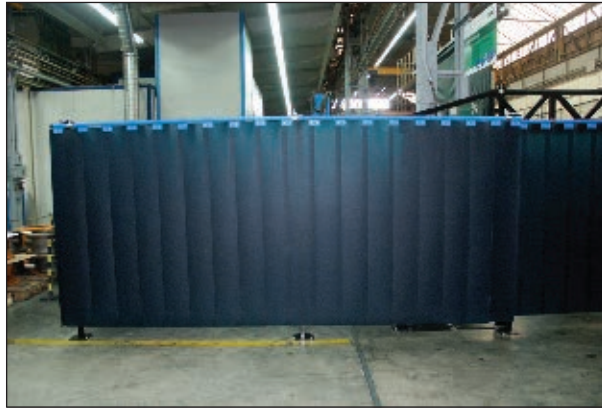
Сварочные перегородки с жалюзиными занавесками
