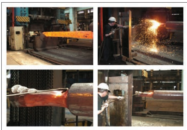
Рис. 5. Выплавка дефектов на поковках резаком РПКЗ под прессом усилием 3000 т
