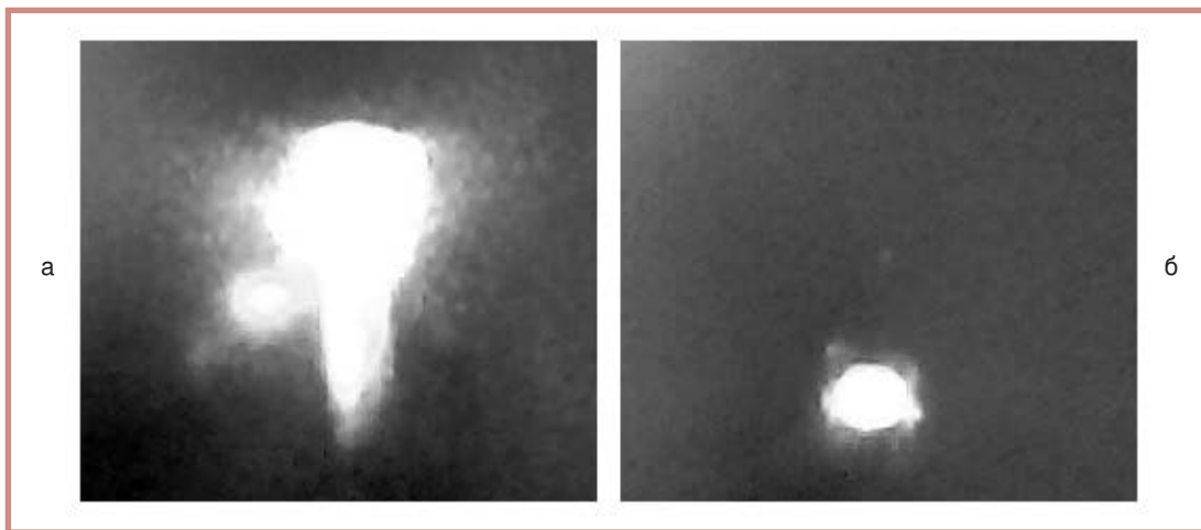
Рис. 4. Вид образовавшегося под действием лазерного излучения парового потока над образцом из стали 09Г2С при выполнении наплавочных швов в атмосфере аргона (а) и при пониженном давлении (б)
