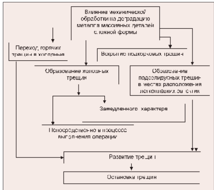
Рис. 8. Схема деградации металла под влиянием лезвийной обработки массивных деталей сложной формы
