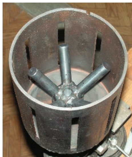
Рис. 2. Внешний вид (а) и конструкция (б) газовой горелки ГВ-ВО для мемориальных комплексов
