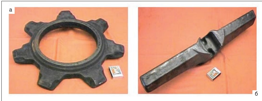
Рис. 3. Венцы шахтных конвейеров типа СП (а) и скребки конвейеров (б), изготовленные способом электрошлакового кокильного литья
