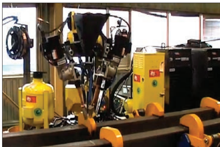
Рис. 16. Двухдуговая установка для сварки внутреннего шва хребтовой балки
