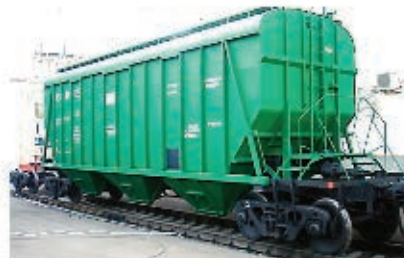
Рис. 3. Вагон-хоппер модели 19-9835 для перевозки минеральных удобрений с нагрузкой от оси колесной пары на рельсы 23,5 т
