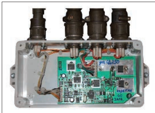
Рис. 6. Блок управления электродвигателем постоянного тока (крышка снята)
