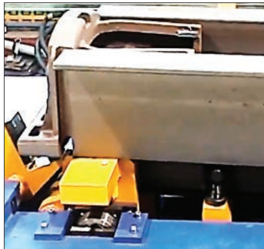
Рис. 12. Установка для сварки внутреннего шва хребтовой балки: 1 — стенд; 2 — транспортная система; 3 — платформы с роботами и сварочными источниками питания; 4 — пульт управления; 5 — ограждение
