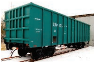
Рис. 1. Полувагон модели 12-9833 с глухим кузовом с нагрузкой от оси колесной пары на рельсы 23,5 т
