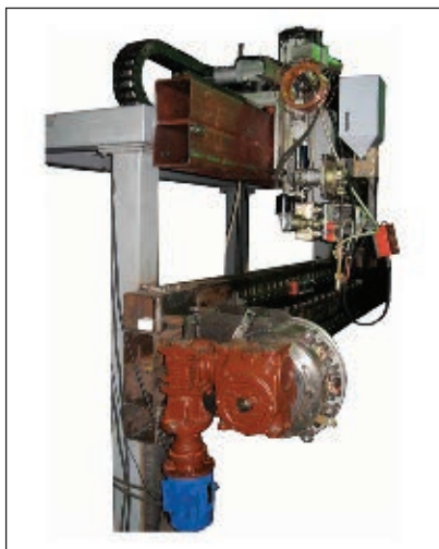
Рис. 9. Установка КТС 3-33 для наплавки валов в защитных газах
