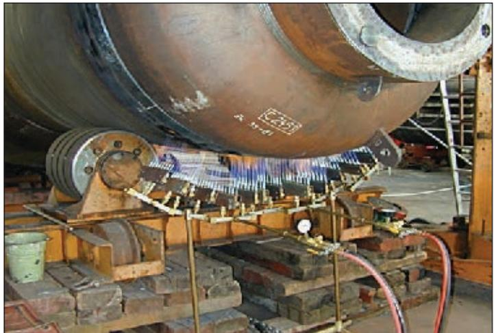
Подогрев при производстве нефтехимического оборудования
