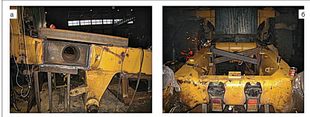
Рис. 4. Установка новой центральной поперечной опоры с использованием дополнительных ребр жесткости (а) и общий вид узла рамы после восстановления (б)
