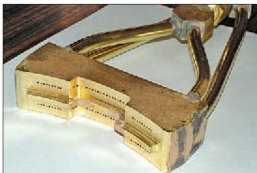
Рис. 5. Головка горелки для закалки поверхности шлицевых валков
