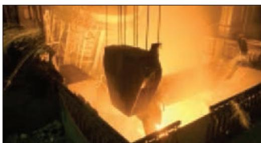
вые перевозка слитка, температура которого составляет 500°C, из сталеплавильного цеха в кузнечно-прессовый осуществлена автотранспортом. Для этого потребовалось разработать и изготовить специальный термос и использовать специальную технику.
