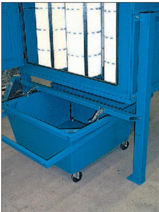
Насыщение фильтр-патрона контролируется автоматически. Как только количество пыли на фильтр-патроне достигает своей максимально заданной величины, автоматически запускается очистка фильтр-патрона.
