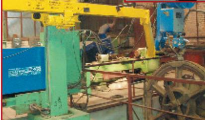
**ИЗРМ-5** — универсальная установка автоматической дуговой наплавки малогабаритных цилиндрических деталей
