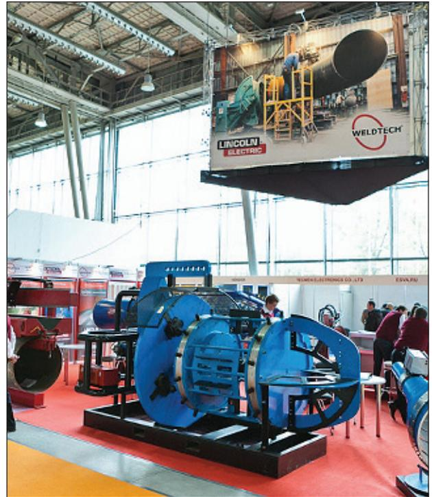
установки для низкочастотной виброобработки металлоконструкций ВТУ01МП.02.
