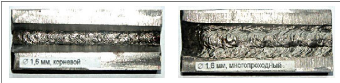
Рис. 1. Внешний вид сварных швов при мокрой подводной сварке высоколегированной коррозионно-стойкой стали типа 18–10
