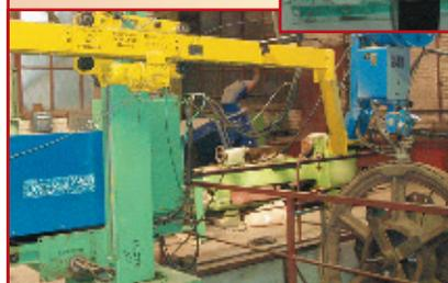
РМ-15 — универсальная установка автоматической дуговой наплавки деталей горного оборудования
