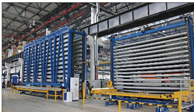
Рис. 12. Механизированные склады на ООО «UzAutoTrailer».
