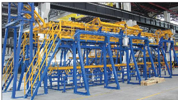
Рис. 10. Универсальный стенд сборки изотермического кузова
