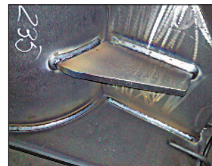
Рис. 3. Внешний вид швов, выполненных с использованием робота
