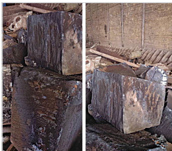
Рис. 8. Поверхность реза. Прибыльная часть слитка из стали 08Х18Н10Т диаметром 1300 мм и высотой 500–600 мм разрезана на четыре части
