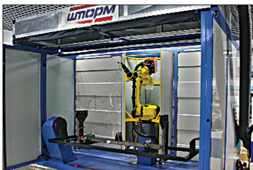
Рис. 7. Комплекс для сварки изделия «Стойка»
