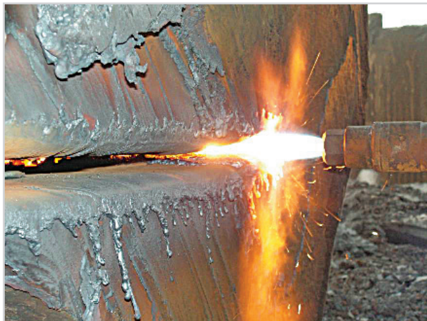
Рис. 3. Процесс кислородной резки запатентованным способом
