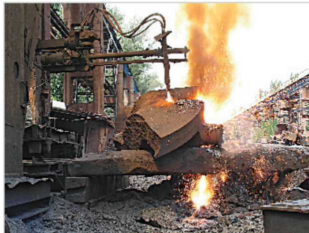
Рис. 4. Экспериментальная резка чугунного корпуса на металлолом
