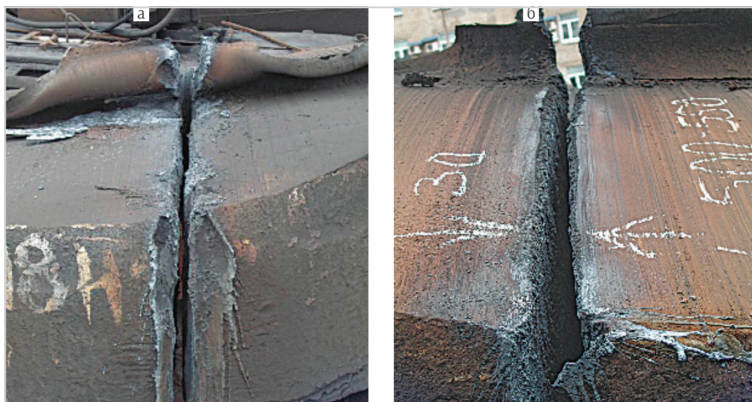
Рис. 6. Полость реза со стороны начала резки (а), и со стороны окончания резки (б). Диаметр прибыльной части слитка 1300 мм, высота от 500 до 600 мм. Сталь 08Х18Н10Т
