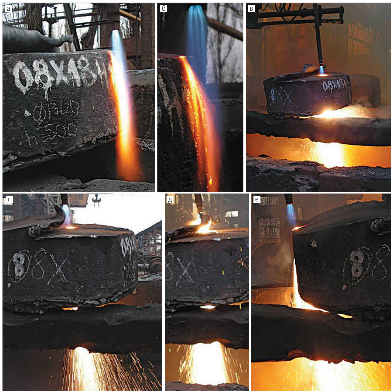
Рис. 5. Процесс резки прибыльной части слитка из стали 08X18H10T. Диаметр заготовки 1300 мм, высота 500–600 мм: а — прогрев нижней части заготовки; б — момент пуска основной режущей струи, врезание; в — резка заготовки в ее центральной части; г — резка над заусеницей; д — резка через заусеницу высотой 150 мм; е — выход кислородной струи из заготовки, окончание резки
