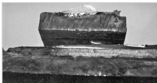
Рис. 6. Внешний вид излома сварного шва, наплавленного электродами ЭЖТ-1 на пластину из стали 3
