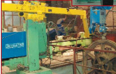
PM-15 — универсальная установка автоматической дуговой наплавки деталей горного оборудования
