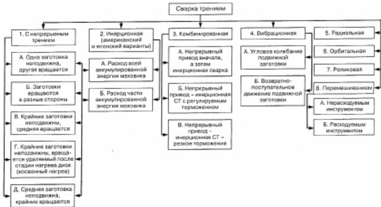
Рис. 1. Классификация способов сварки трением
