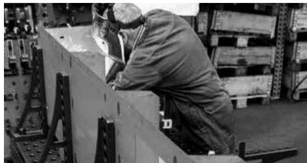
Рис. 16. Сварка боковой стенки моторного вагона
