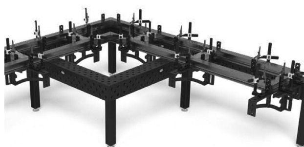
Рис. 7. Пример применения блок-балок для создания стапеля для сварочных работ с рамными конструкциями
