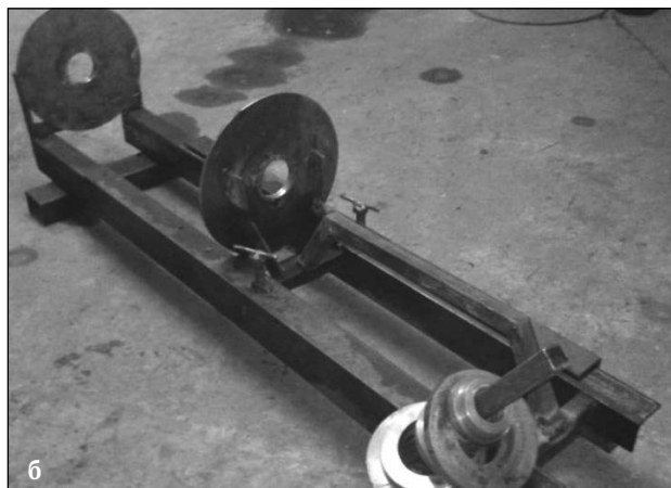
Рис. 1. Плита с пазами для универсального сборочного приспособления (а) и кондуктор для приварки фланцев (б)
