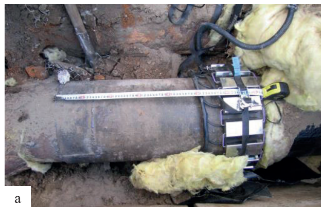
Рис. 7. НЧ УЗК «Универсал-2П» 16 кГц (а), НЧ УЗК «Универсал-1П» 36 кГц (б)
