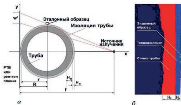
Рис. 5. Тангенциальное просвечивание трубы: а – схема просвечивания, б – цветовая селекция результатов контроля толщины стенки трубы
