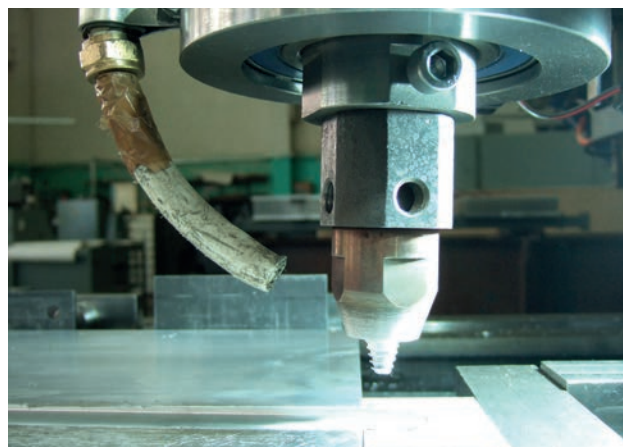
Рис. 9. Воздушное охлаждение инструмента.
