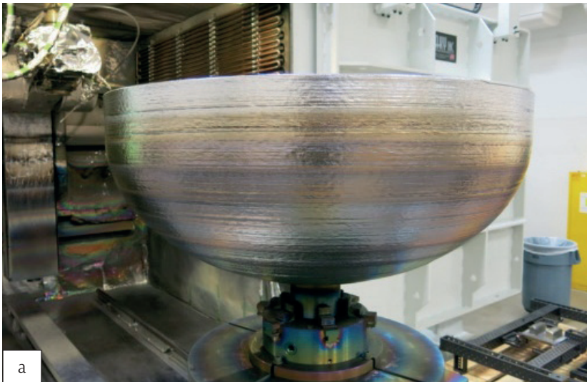
Рис. 1. Бак ракетного топлива (а) и электронно-лучевая камера для 3D-печати (б)
