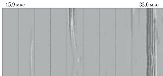
Рис. 8. Пример измерения в сварном соединении трещины методом TOFD
