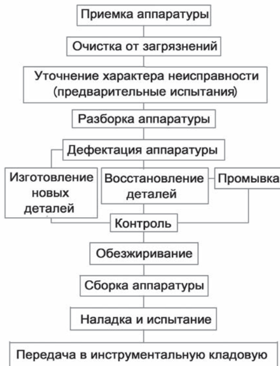
Рис. 1. Схема технологического процесса ремонта ющим допуск к выполнению газорезательных или газосварочных работ.
