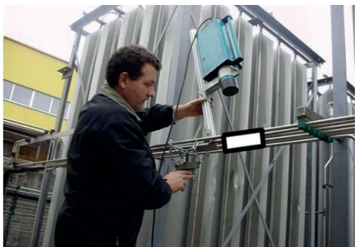
Рис. 3. Рентгентелевизионный неразрушающий контроль
