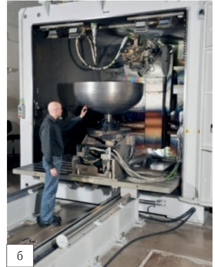
Рис. 1. Бак ракетного топлива (а) и электронно-лучевая камера для 3D-печати (б)
