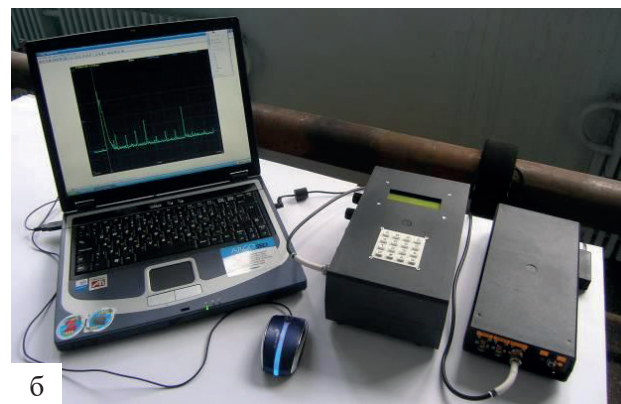
Рис. 7. НЧ УЗК «Универсал-2П» 16 кГц (а), НЧ УЗК «Универсал-1П» 36 кГц (б)
