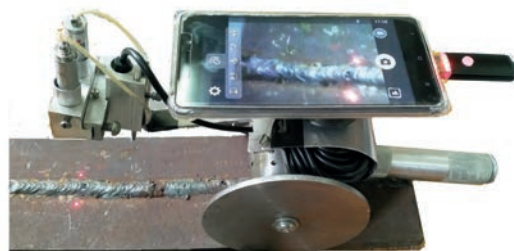
Рис. 2. Автоматизированная система визуального контроля на базе подвижного намагничивающего устройства
