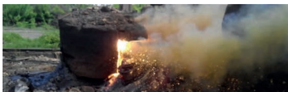
Рис. 21. Кислородная резка чугуна «козла» диаметром 2400 мм в полевых условиях с помощью переносной машины УОПП-1
