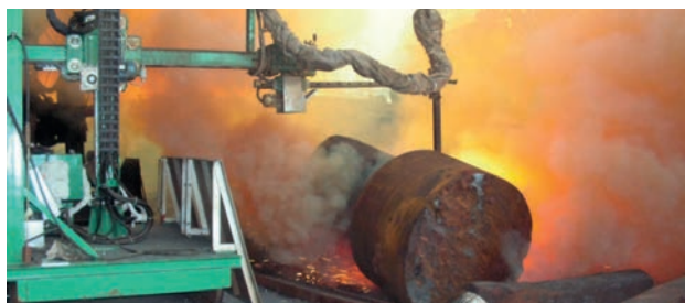
Рис. 22. Процесс резки шейки прокатного валка вертикальным резаком при движении его к машине
