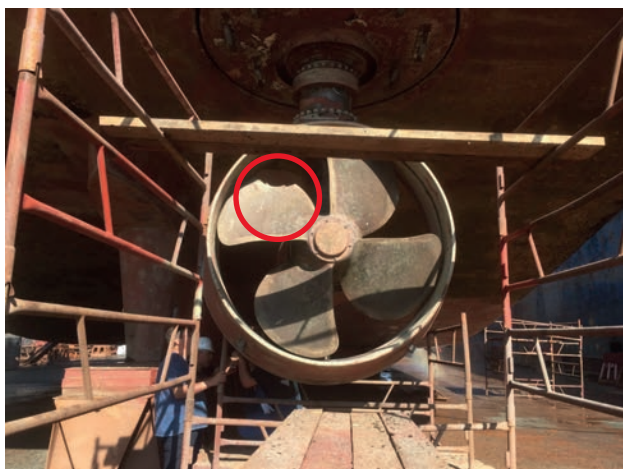
Рис. 1. Полуавтоматическая сварка в инертном газе (MIG 131). Ремонт бронзового гребного винта (Cu3), т/х «SAIR VAQIF». До ремонта пяти, шести, семи – лопастные.
