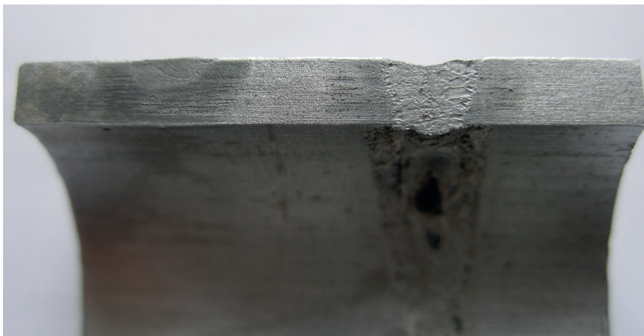
Рис. 3. Макроструктура сварного соединения образца – имитатора трубных элементов спирали ПВД (неповоротных стыков), полученного с помощью автоматической орбитальной гелиодуговой сварки методом автоопрессовки, где слева представлен шов, который сформирован за один проход автоматической орбитальной гелиодуговой сваркой методом автоопрессовки, а справа – шов, сформированный автоматической орбитальной аргонодуговой сваркой тем же методом
