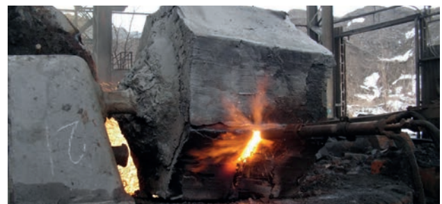
Рис. 17. Резка недоливка толщиной 1600 мм на габаритные куски. Резка горизонтальным резаком снизу – вверх. Процесс резки
