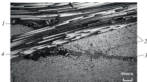
Рис. 4. Микроструктура образца углепластика [10]: 1 – макропоры; 2 – филаменты; 3 – микропоры; 4 – клей
