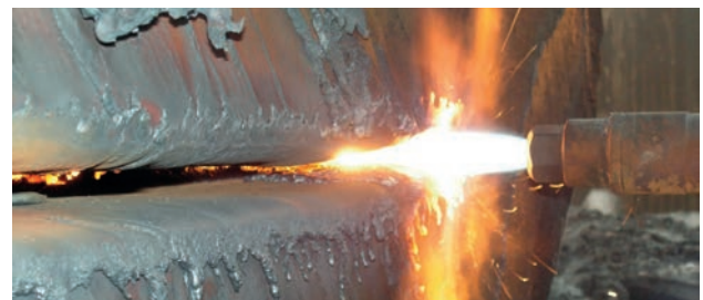
Рис. 18. Резка диска толщиной 1000 мм, отрезанного от недоливка. Перемещение резака слева - направо. Процесс резки и полость реза
