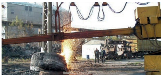
Рис. 11. Кислородная резка скрапины толщиной 1100 мм
