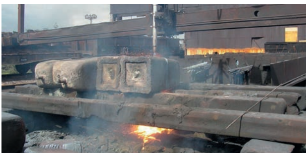
Рис. 14. Резка слитков толщиной 800 мм
