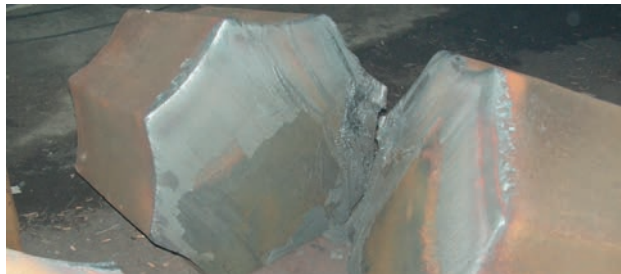
Рис. 10. Кислородная резка передельного слитка поперек его продольной оси. Толщина 1200 мм. Поверхность реза
