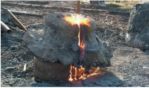
Рис. 12. Кислородная резка скрапины толщиной 1100 мм. Корона отраженного пламени и поток шлака
