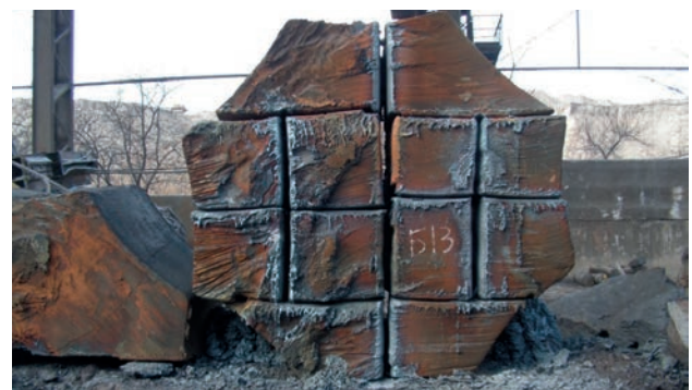
Рис. 19. Разделанный на габаритные куски диск толщиной 1000 мм недоливка диаметром 1600 мм
