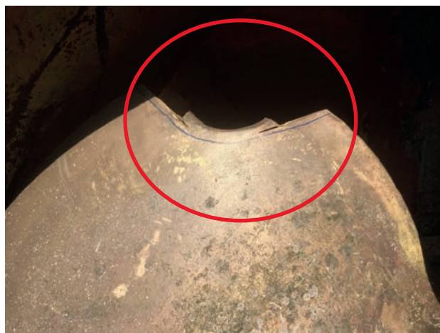
Рис. 1. Полуавтоматическая сварка в инертном газе (MIG 131). Ремонт бронзового гребного винта (Cu3), т/х «SAIR VAQIF». До ремонта пяти, шести, семи – лопастные.
