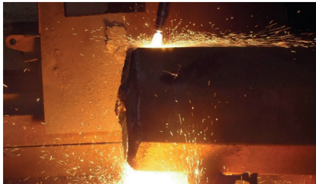
Рис. 9. Процесс кислородной резки передельного слитка вдоль его продольной оси. Толщина 1200 мм. Начало резки с донной части слитка
