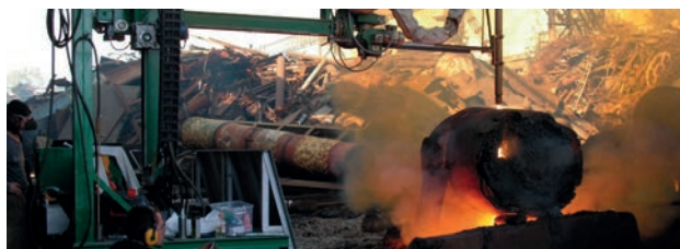
Рис. 24. Процесс резки прибыльной части слитка толщиной 1200 мм вертикальным резаком при движении его от машины газовой резки
