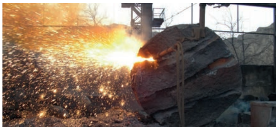
Рис. 20. Кислородная резка чугуна «козла» диаметром 1500 мм и длиной 2000 мм. Резка горизонтальным резаком слева – направо
