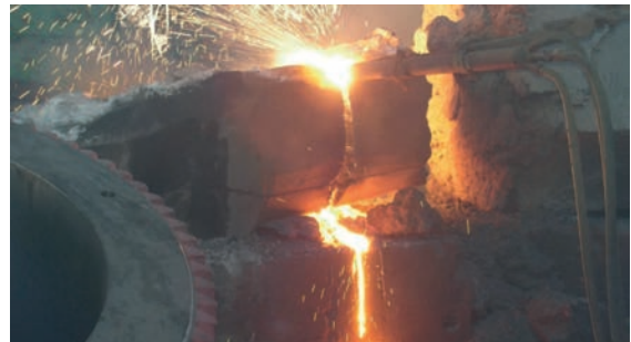
Рис. 16. Процесс резки поковки на габаритные куски. Резка горизонтальным резаком снизу – вверх. Окончание резки
