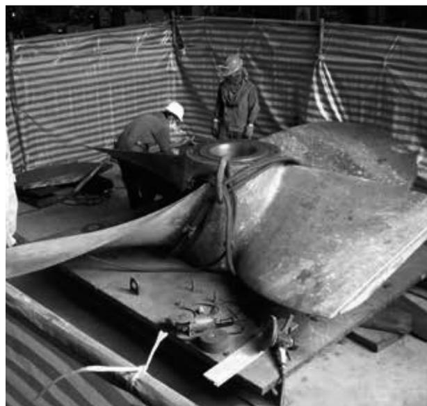
Рис. 1. Гребной винт без отрезанных (поврежденных) частей лопастей
