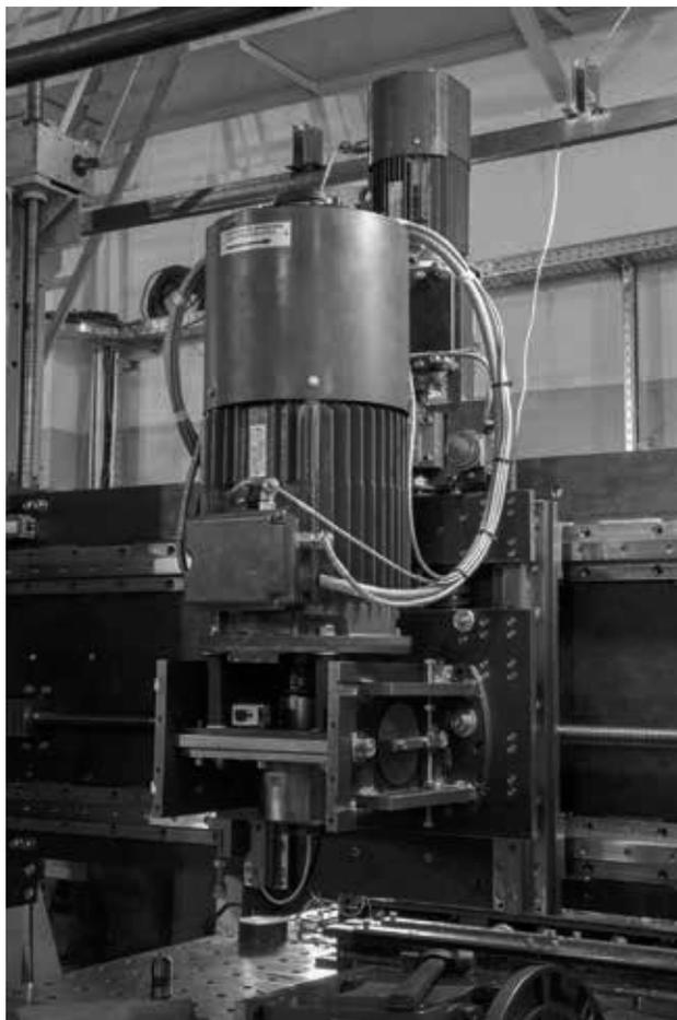
Рис. 3. Конструкция суппорта установки
