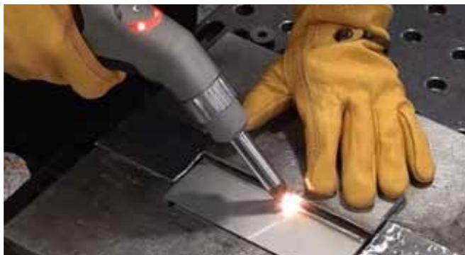
**Встроенная система качания луча для повышения производительности**
