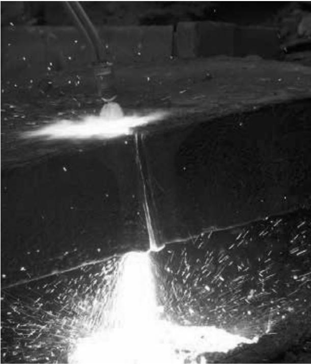
Рис. 14. НКМЗ. Процесс резки плиты толщиной 200 мм
