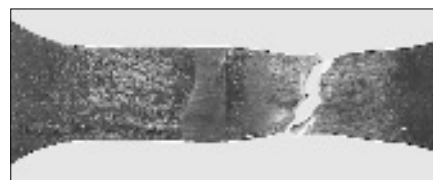
Рис. 1. Образец по ГОСТ 6996, тип XIII после испытаний на статическое растяжение
