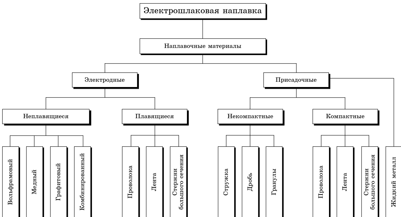
Рис. 2. Классификация способов ЭШН по наплавочным материалам
