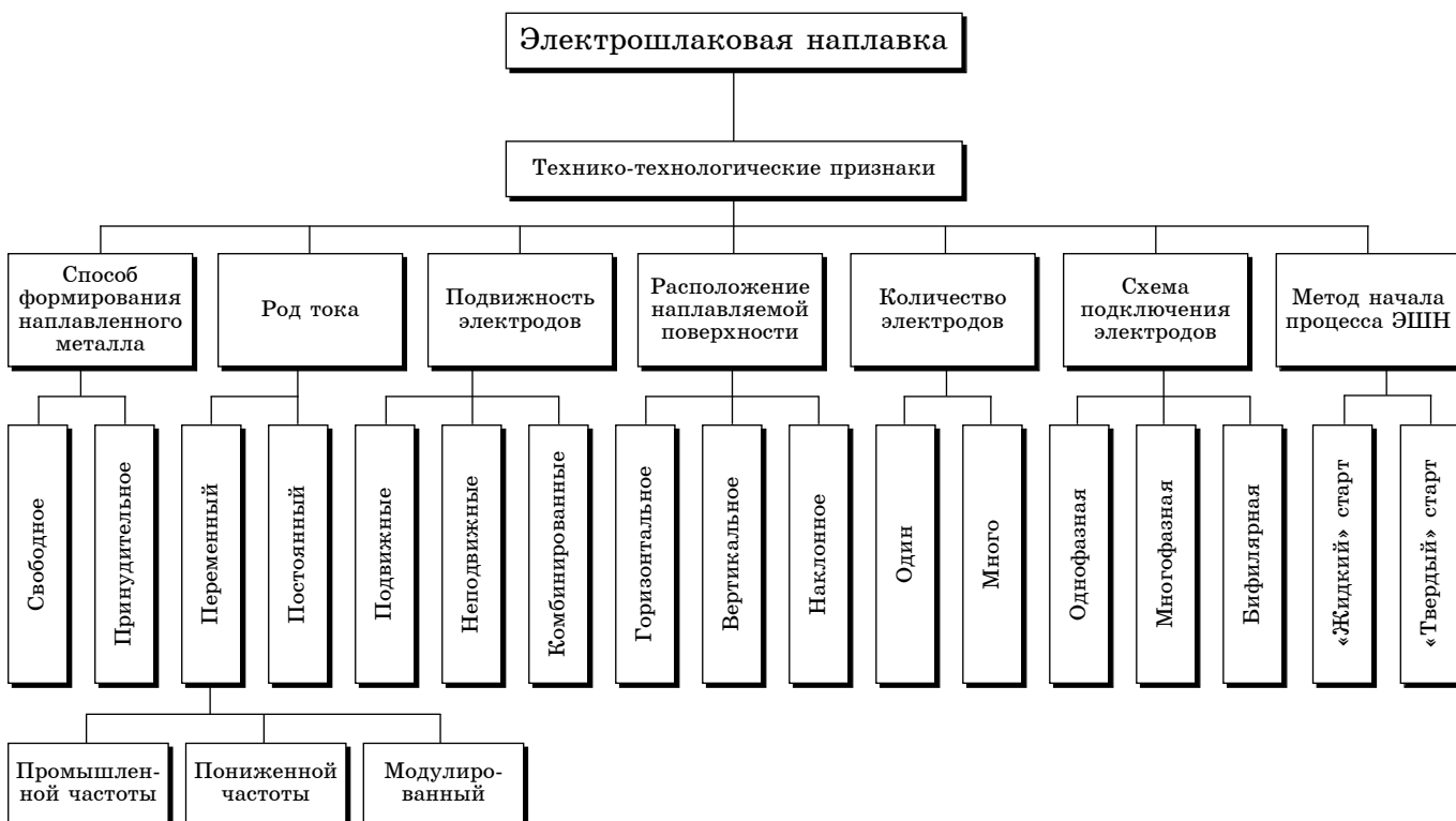
Рис. 1. Классификация способов ЭШН по технико-технологическим признакам
