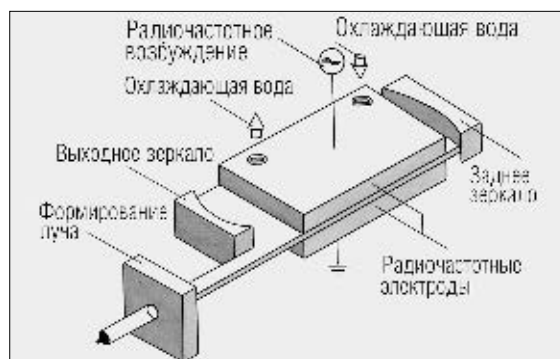
Рис. 3. Пластинчатый CO 2 -лазер
