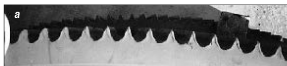
Рис. 5. Внешний вид изношенных зубьев (а) и профиль зуба венца (б): 1 — изношенный; 2 — номинальный; 3 — наплавленный
