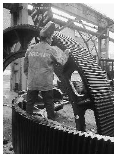
Рис. 6. Внешний вид восстановленных и механически обработанных секторов зубчатого венца шаровой мельницы
