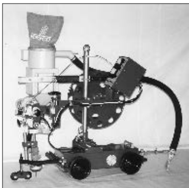
Стационарная машина для контактной стыковой сварки рельсов к железнодорожным крестовинам К-924
