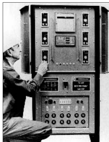
Рис. 2. Общий вид программного многоканального пульта для подводной термообработки сварных соединений
