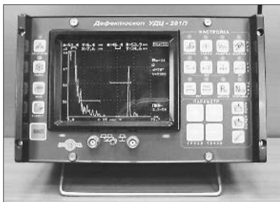
Рисунок. Портативный ультразвуковой процессорный дефектоскоп УДЦ-201П
