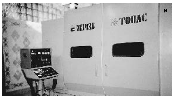
Рис. 1. Полуавтомат абразивно-струйной обработки коленчатого вала (а) и размещение коленчатого вала в камере абразивно-струйной обработки (б)
