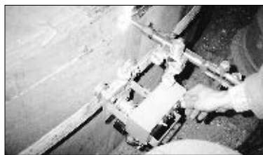
Рис. 1. Способы применения устройства АДК-334 для газопламенной резки: а — в нижнем положении — прямой рез; б — в нижнем положении — кольцевой рез; в — в нижнем положении — криволинейный рез; г — для перемещения держателя сварочного полуавтомата
