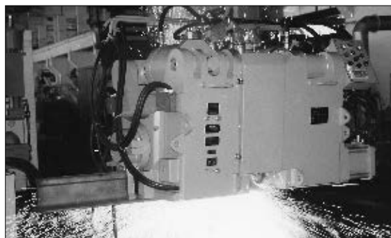
Машина для контактной стыковой сварки рельсов в пути К-920
