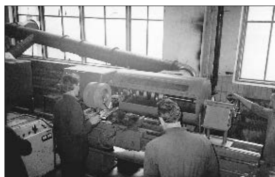
Рис. 3. Участок для восстановления коленчатых валов на предприятии «Агротехсервис»
