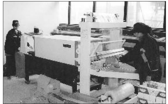
Рис. 3. Упаковка готовых электродов в термоусадочную пленку
