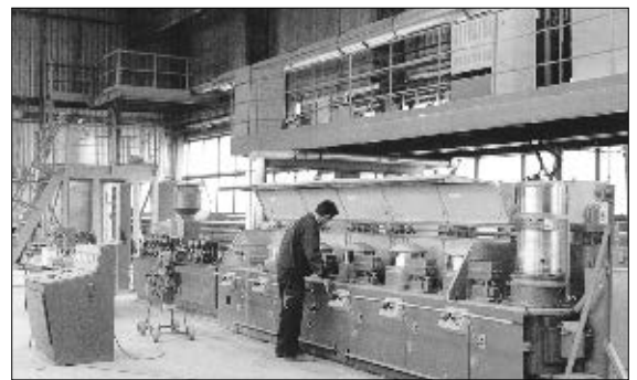
Рис. 4. Линия формовки и предварительного волочения порошковой проволоки
