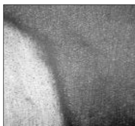
Рис. 2. Микроструктура сварного шва (темный) и основного металла (светлый), выполненного при сварке в среде аргона с охлаждением ( \times 600 )
