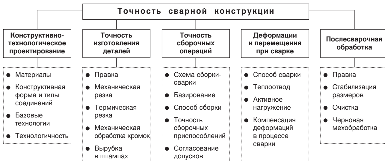
Рисунок. Схема влияния различных факторов при проектировании и изготовлении на точность сварных конструкций
