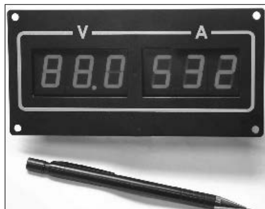
Рис. 1. Устройство цифровой индикации напряжения и тока сварочного выпрямителя
