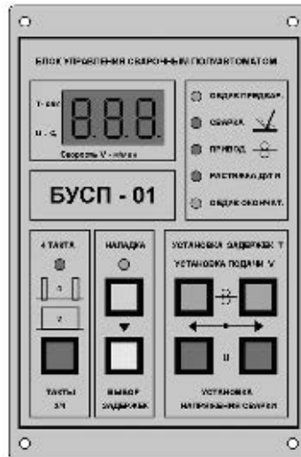
Рис. 2. Блок управления сварочным полуавтоматом (БУСП)
