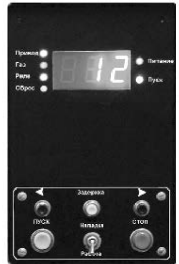
Рис. 3. Блок управления малогабаритной машиной для термической резки
