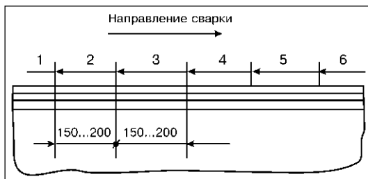
Рис. 1. Схема заварки трещины длиной более 300 мм
