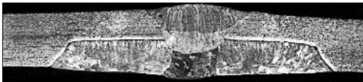
Рис. 2. Схема разделки биметаллических кромок под сварку и макрошлиф комбинированного сварного соединения
