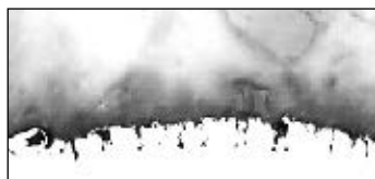
Рис. 4. Вид поперечного сечения образца № 32. Отсутствие медного покрытия, надрывы верхнего слоя проволоки
