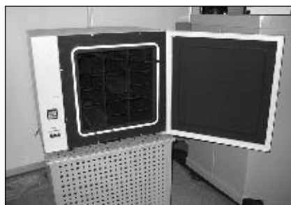
Печь СНОЛ 75/400 для прокаливания до 75 кг сварочных электродов
