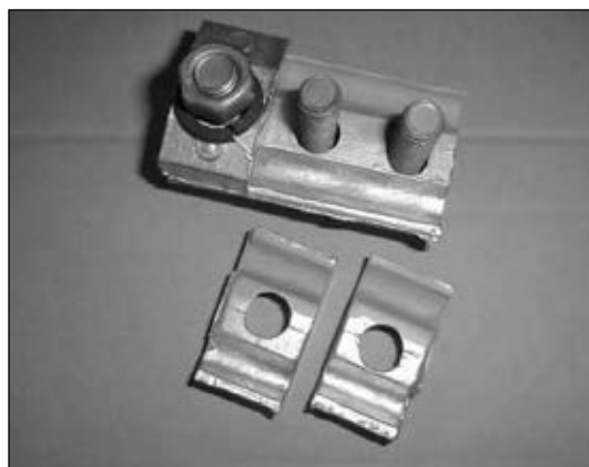
Рис. 5. Нанесение медного покрытия на алюминиевые зажимы-соединители для ЛЭП
