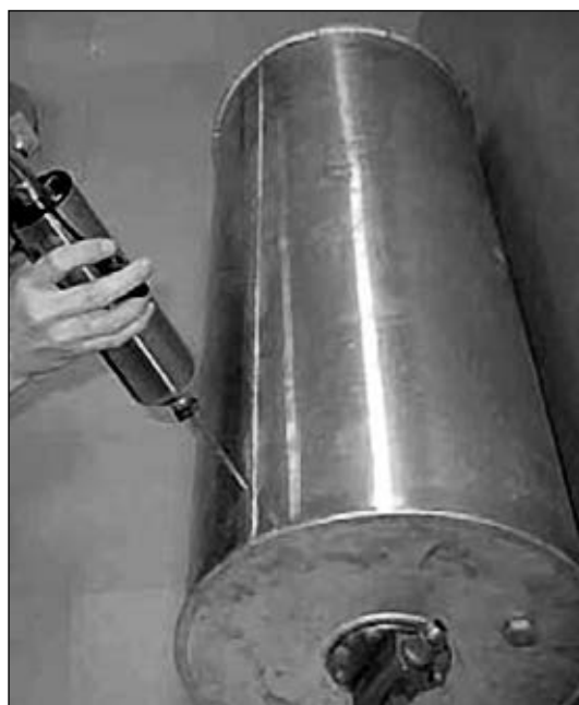
Рис. 4. Герметизация течей емкостей из термоупрочненного алюминия
