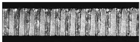
Рис. 3. Продольное сечение круглых отверстий диаметром 0,2 мм после электронно-лучевого сверления стальной пластины толщиной 3 мм
