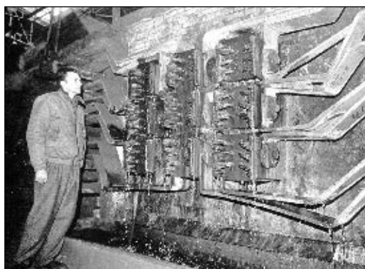
Рис. 4. Задний торец печи Ачесона на 100 кА для производства графитированных электродов
