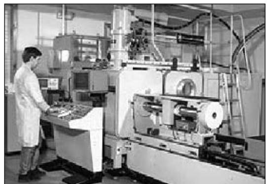
Рис. 4. Установка фирмы «Steigerwald Strahltechnik GmbH (ФРГ) с телевизионным наблюдением для электронно-лучевого сверления сталей, сталита и неметаллов толщиной 0,5–5 мм
