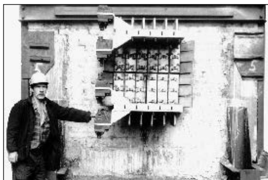
Рис. 5. Один из торцов печи Ачесона на 20 кА для синтеза карбида кремния
