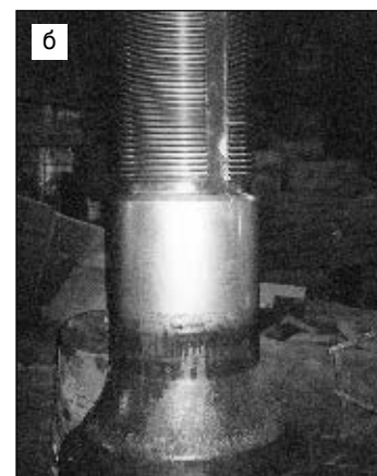
Рис. 4. Наплавленный дробящий конус с устройством для механической обработки (а) и внешний вид наплавленного конуса после механической обработки (б)
