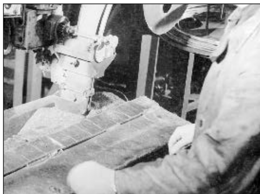
Наплавка чугунной лентой бил молотковой дробилки
