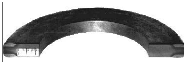
Рис. 3. Макрошлиф наплавленной заготовки дискового ножа диаметром 206 мм
