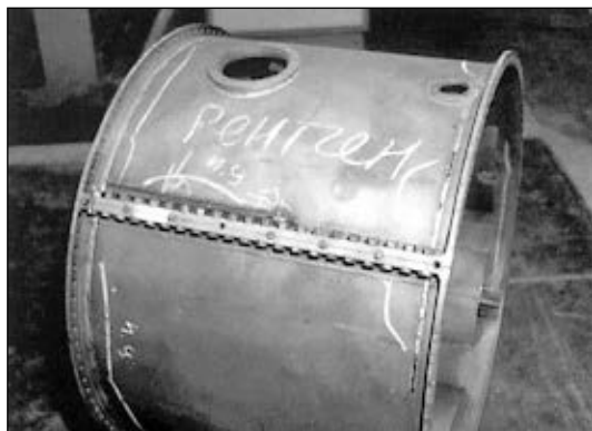
Рис. 12. Камера сгорания после электронно-лучевой сварки (сплав ЭИ-602)
