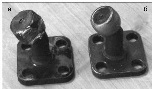
Рис. 3. Фиксаторы диаметром 27 мм из стали 14X17H2, наплавленные вручную прутками (а) и плазменно-порошковой наплавкой (б)
