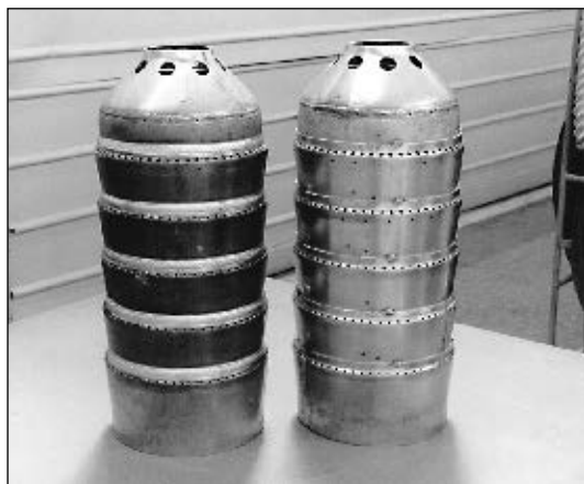
Рис. 5. Жаровая труба (сплав ЭИ-602, \delta=2,5 мм) с пятью кольцевыми швами, выполненными ЭЛС
