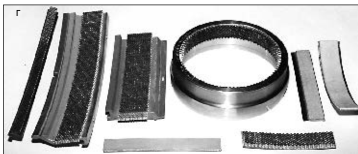
Рисунок. Примеры паяных изделий: а — воздушные и топливные фильтры, клеммники датчика ЛТН-240; б — лопатки сопловых аппаратов, обоймы поворотных лопаток, корпуса воспламенителей; в — пакеты и лопатки сопловых аппаратов (исправление поверхностных дефектов литья); г — сотовые и металлокерамические уплотнения
