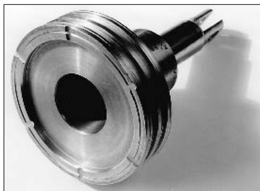
Рис. 1. Образование трещин при наплавке бронзы
