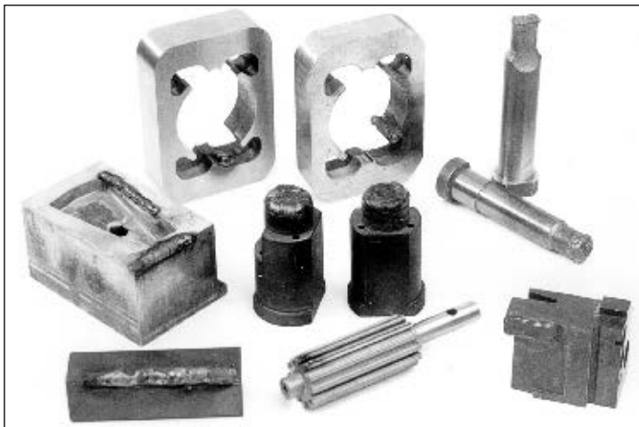
Рис. 3. Вырубные штампы и детали, восстановленные микроплазменной наплавкой
