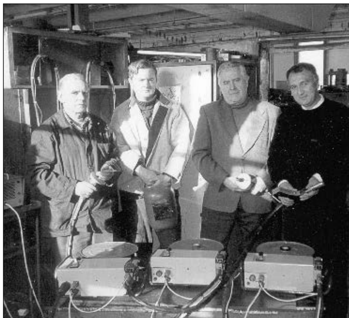
Рис. 1. Комплекс полуавтоматов типа ПШ107 для сварки, наплавки и резки
