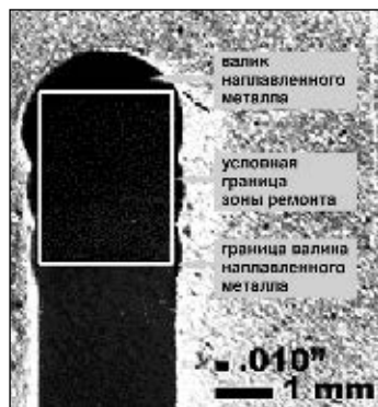
Рис. 1. Валик, сформированный лучом лазера (см. текст)
