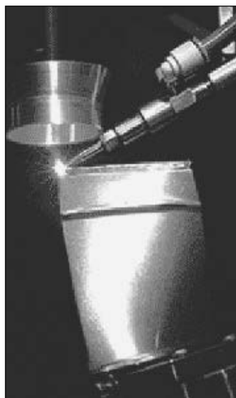
Рис. 1. Валик, сформированный лучом лазера (см. текст)
