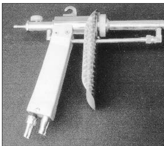
Рис. 1. Схема прямооточной горелки для сверхзвукового газопламенного напыления
