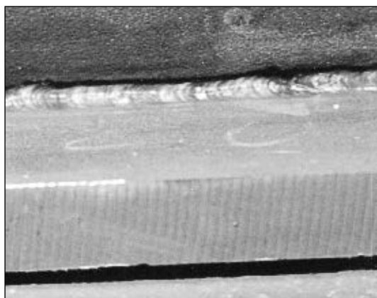
Рис. 2. Сварка таврового соединения без присадки в защите смеси — 80% Ar+20% CO 2
