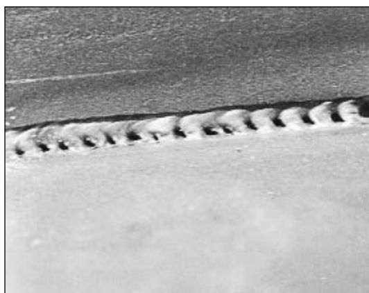
Рис. 1. Сварка таврового соединения без присадки в аргоне
