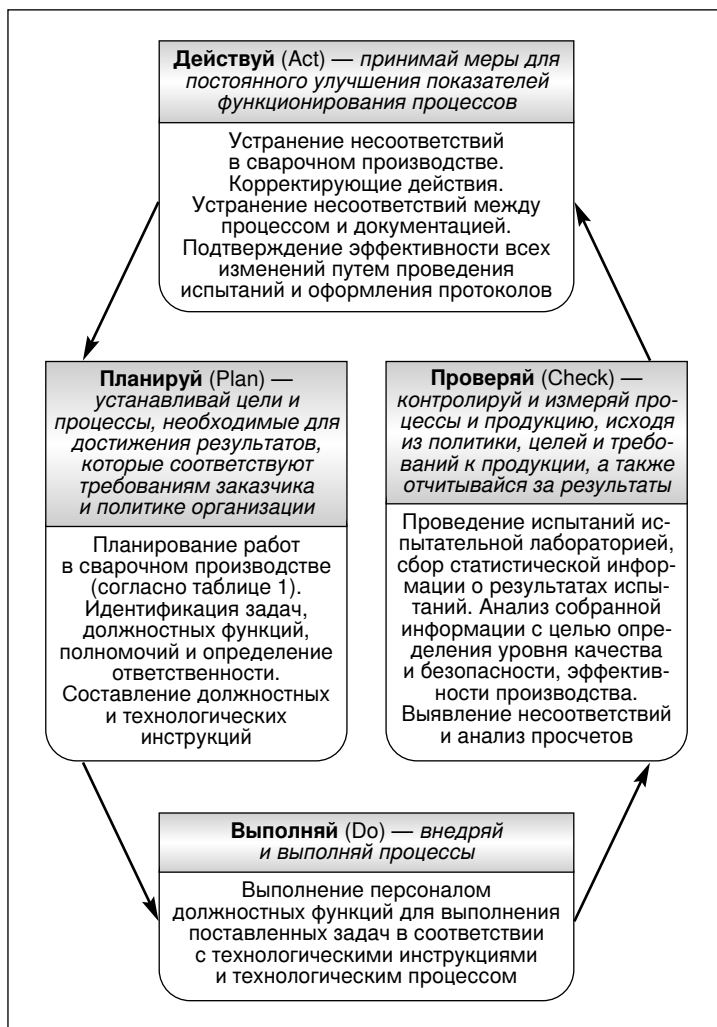
Рисунок. Алгоритм эффективной координации сварочных работ при производстве сварных конструкций согласно ISO 14731:1997 и ДСТУ ISO 9000–2001
