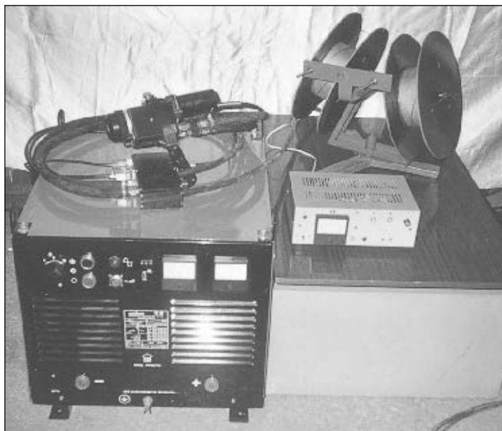
Рис. 2. Комплект установки АДМ–10, включающий аппарат, источник питания ВДГ–401, пульт управления, блок коммутации, катушки для проволоки
