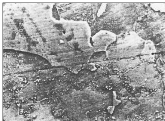
Рис. 2. Микроструктура зоны соединения «труба — трубная решетка» (×1000)
