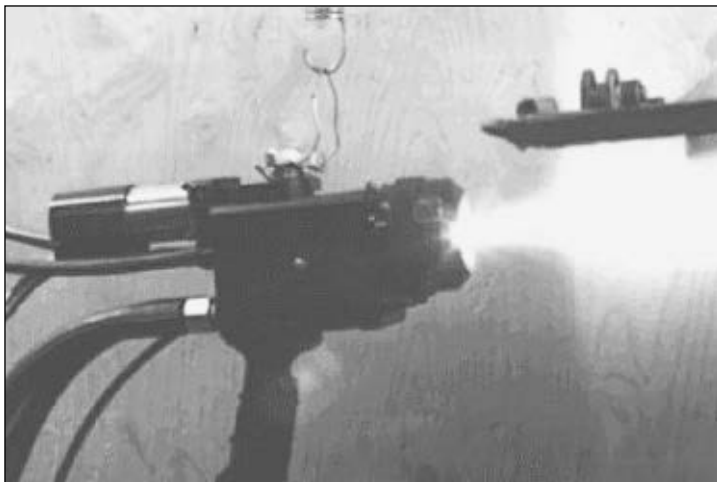
Рис. 1. Напыление стали АДМ-аппаратом
