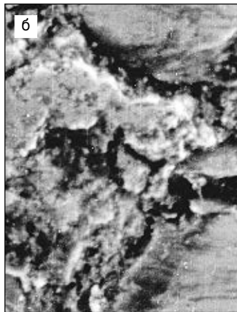
Рис 2. Микроструктура покрытия после триботехнических испытаний ( \times 150 ): а — прямоугольником обведен фрагмент сплава АЛО20–1 в порах покрытия на фоне оксидной пленки; б — то же при увеличении \times 900
