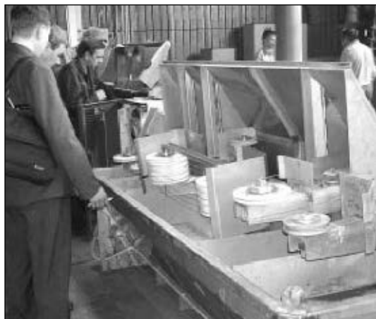
Рис. 1. Линия химического меднения сварочной проволоки
