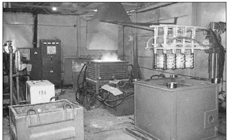
Рис. 4. Участок для наплавки деталей гидротрансмиссий в боратном теплоносителе на заводе «Гидросила»
