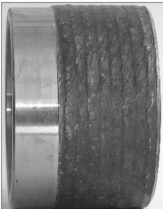
Рисунок. Фрагмент ролика МНЛЗ диаметром 140 мм, наплавленный порошковой проволокой ВЕЛТЕК- Н470С
