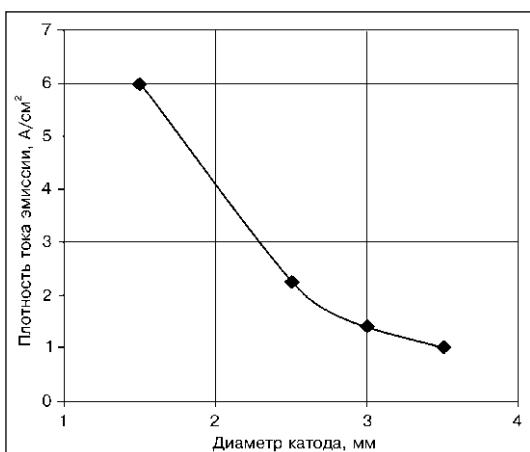
Рис. 4. Зависимость плотности тока эмиссии от диаметра рабочей части Т-образного катода из монокристаллического гексаборида лантана (сила тока электронного пучка 100 мА, ускоряющее напряжение 60 кВ)
