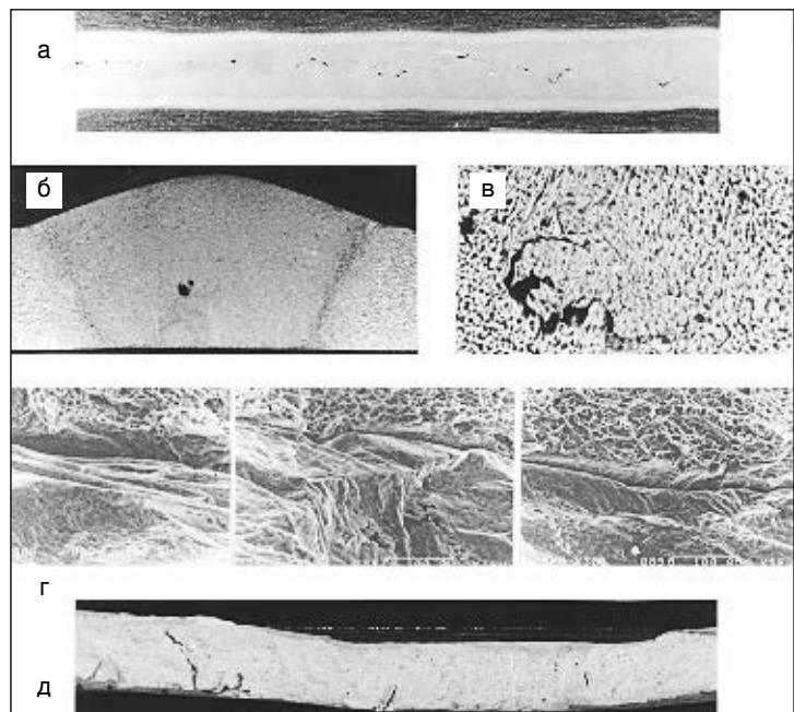
Рис. 1. Включения оксидной пленки в швах сплава АМг6 толщиной 6 мм: а — обратная сторона шва с выходящими на поверхность включениями оксидной пленки после снятия проплава и химического травления; б — поперечный макрошлиф сварного соединения с не выходящими на поверхность шва включениями оксидной пленки; в — микрошлиф шва с включениями оксидной пленки; г — фрактограмма поверхности излома шва с включениями оксидной пленки; д — продольный излом шва
