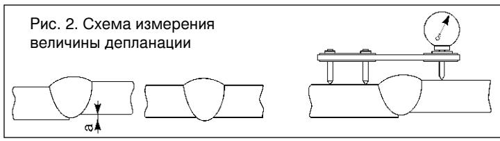
Рис. 2. Схема измерения величины депланации
