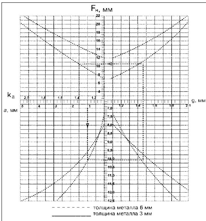
Рис. 3. Номограмма для определения коэффициента k<sub>a</sub>
