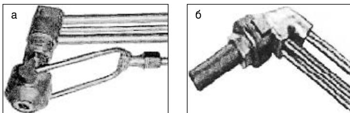
Рис. 3. Смешивающие головки для горелок КФР:
