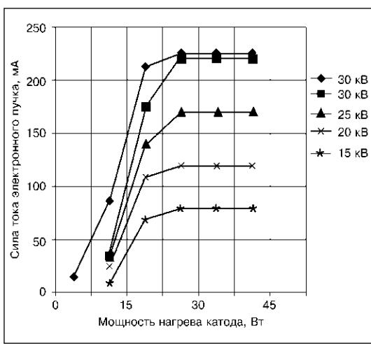
Рис. 5. Накальные характеристики электронной пушки с дисковым (верхняя кривая) и Т-образным (остальные) катодом из монокристаллического гексаборида лантана (ускоряющее напряжение в диапазоне 15–30 кВ)
