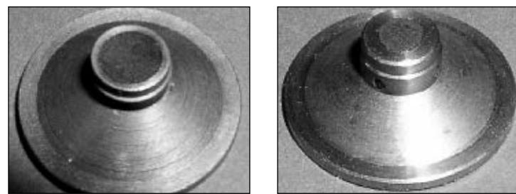
Рис. 2. Катодный узел для сварочной электронной пушки с аксиально-симметричным электронным пучком: а — с дисковым катодом; б — с Т-образным катодом
