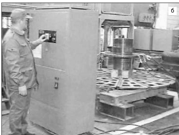
Рис. 3. Размагничивание ротора газовой турбины под электронно-лучевой сварку на НПКГ «Зоря»—«Машпроект»: а — подключение токоведущих кабелей к ротору; б — общий вид участка размагничивания
