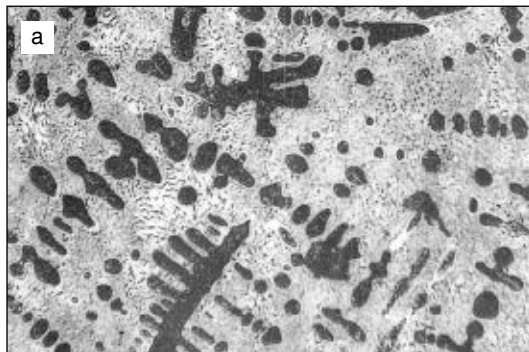
Рис. 1. Микроструктура сплавов-связок Fe–B–C, ×200: а — до легирования; б — после комплексного легирования Si, Al, Mn и P
