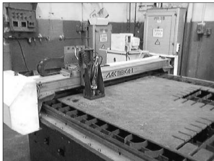
Рис. 3. Автоматизированный технологический комплекс с компьютерным управлением для контурной плазменной резки
