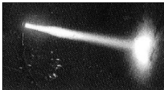
Рис. 2. Напыление никромового порошка сверхзвуковой плазменной струей
