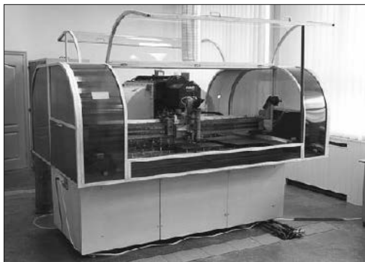
Рис. 1. Автоматизированный технологический комплекс с компьютерным управлением для лазерной резки на базе модернизированного \text{CO}_2 -лазера «Хебр-1А», созданный в ИЭС им. Е. О. Патона
