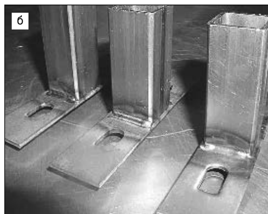
Рис. 2. Роботизированный сварочный комплекс в работе: а — процесс сварки; б — сварные изделия
