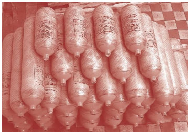
Рис. 1. Внешний вид баллонов типа БК-300С вместимостью 2, 3, 4, 7 л
