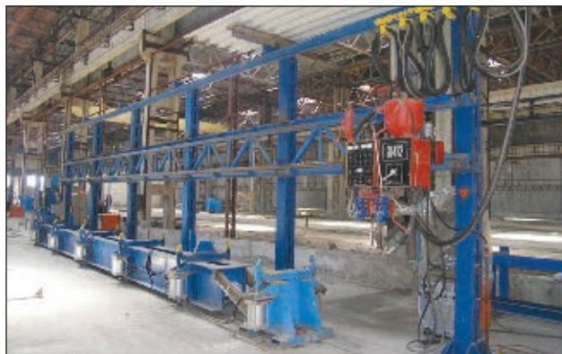
Стенд для автоматической сварки хребтовой балки
