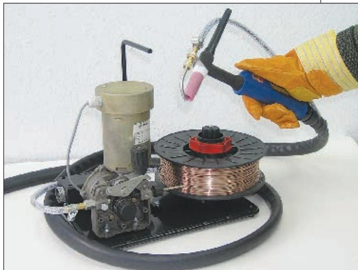
Рис. 3. Ручная сварочная горелка с жидкостным охлаждением
