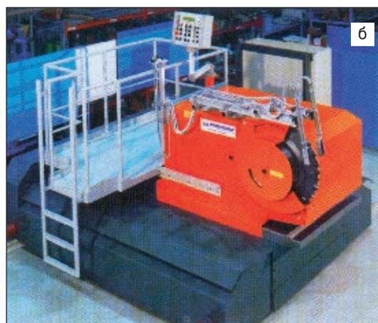
Рис. 1. Специальная фреза (а) для разделки кромок и режущая головка (б)
