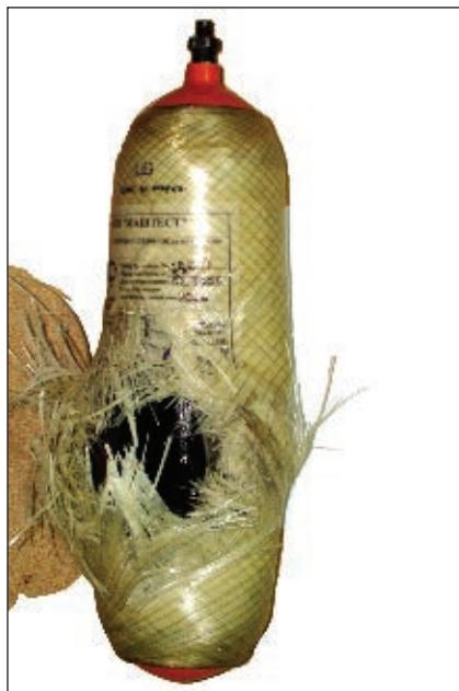
Рис. 3. Баллон БК-7-300С после гидроиспытания до разрушения
