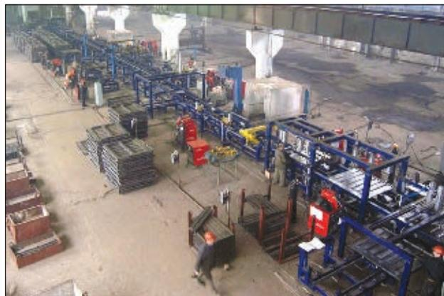
Линия изготовления крышек люков полувагонов
