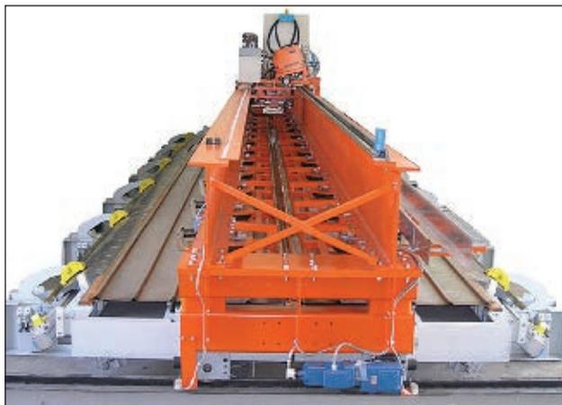
Универсальная установка для автоматической сварки секций обшивки крыши пассажирских вагонов
