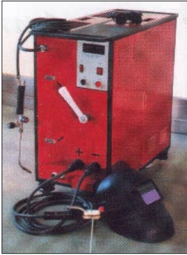
Дуговую сварку можно выполнять на постоянном токе силой до 315 А. Газовую сварку выполняют стандартной ацетилено-кислородной сварочной горелкой. Аппарат переключает весь диапазон расходов газа при работе наконечником №4 и часть диапазона при работе на-
