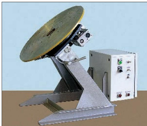
Рис. 2. Сварочный вращатель МВР2
