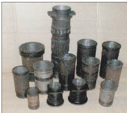
Рис. 6. Цилиндрические втулки с плазменным покрытием
