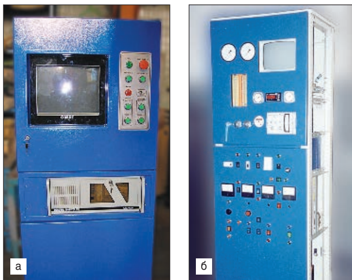
Рис. 4. Шкаф управления полуавтоматом (а) и плазменной установкой ПЛАЗЕР (б)
