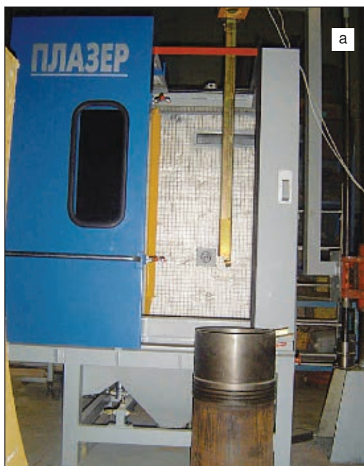
Рис. 3. Полуавтоматы для напыления (а) и абразивоструйной подготовки (б)
