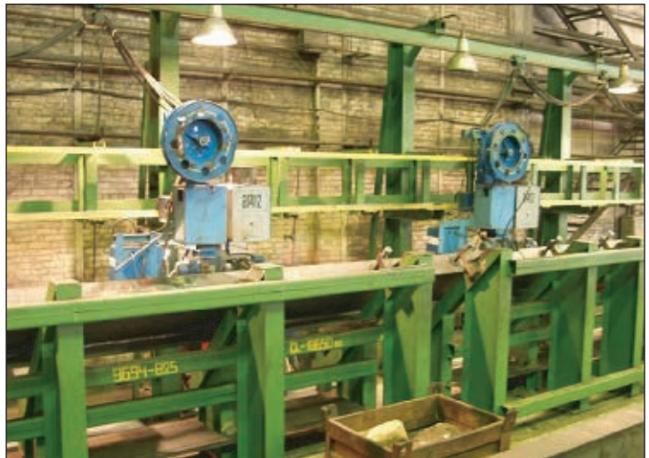
Рис. 3. Установка для сварки двутавра
