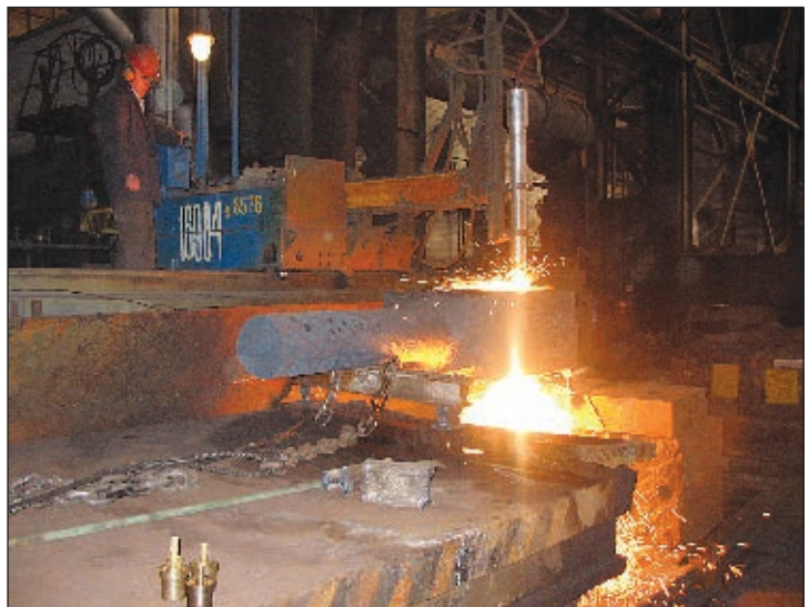
время разработан специальный резак, позволяющий разрезать заготовки толщиной до 1000 мм при температуре до 800°С.
