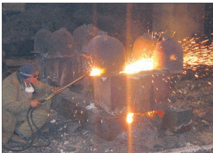
Рис 4. Резка прибылей толщиной 350 и 500 мм
