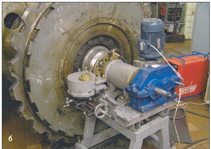
Рис. 2. Наплавка (а) и механическая обработка (б) посадочного места вала на УД–690
