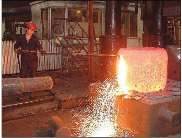
Рис. 2. Удаление дефектов с помощью резака РПКЗ
