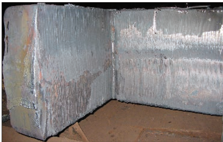
Рис. 8. Поверхность реза при фигурной вырезке детали (толщина заготовки 500 мм)
