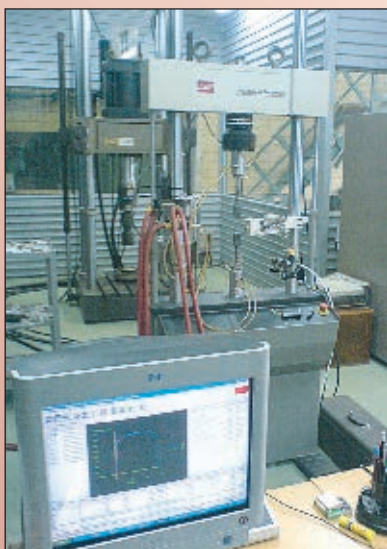
Рис. 1. Испытательная сервогидравлическая установка MTS 810
