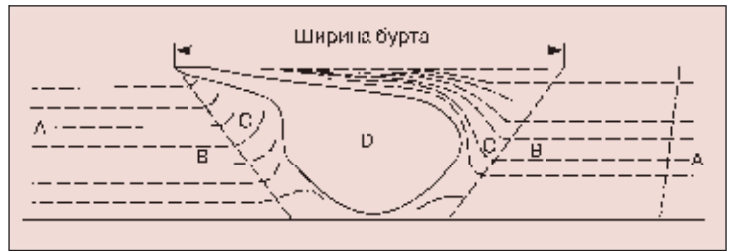
Рис. 8. Схематическое изображение основных зон соединения, полученного сваркой трением с перемешиванием: А — основной металл; В — зона термического влияния (ЗТВ); С — зона термомеханического влияния (ЗТМВ); D — зона динамической рекристаллизации
