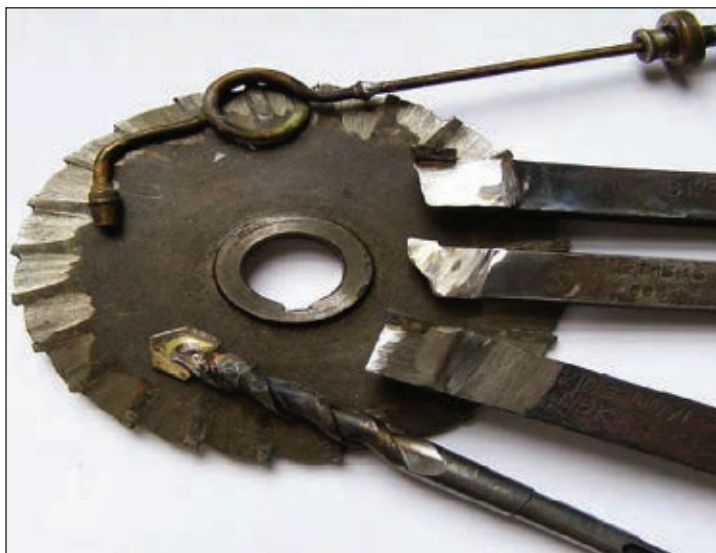
Рис. 1. Режущие инструменты, паяные с использованием водородно-кислородного пламени
