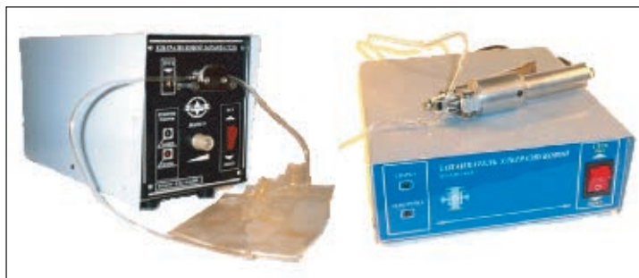
Рис. 5. Ультразвуковые запаиватели пластиковых гемоконтейнеров и трансфузионных систем
