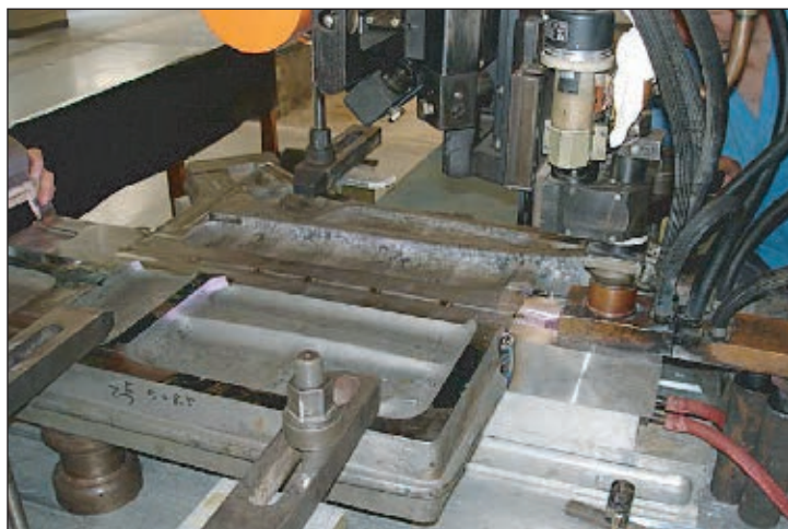
Рис. 2. Процесс сварки погруженным электродом титанового образца
