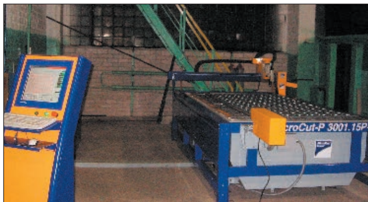
Рис. 3. Установка плазменной резки в ремонтно-механическом цехе завода «Liepajas metalurgs»
