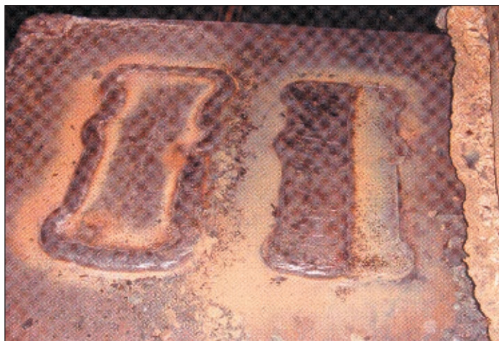
Рисунок. Прессовая матрица с заполняющей наплавкой, готовая к механической обработке
