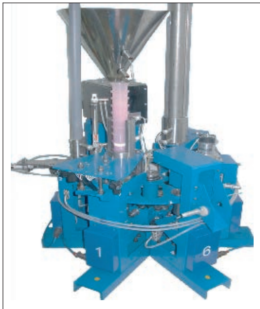
Рис. 10. Автоматизированная линия с аппаратом ультразвуковой сварки
