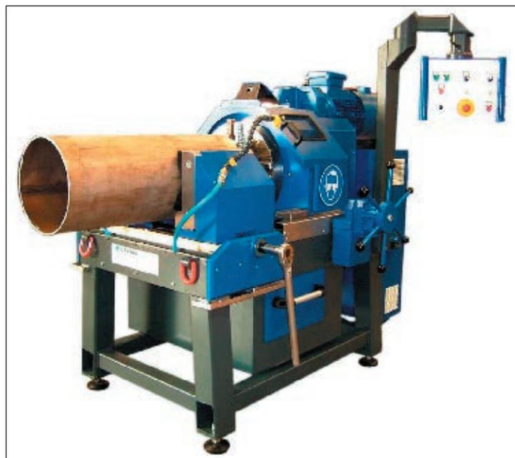
Станки серии PBM (фирма «Th. Wortelboer B. V.», Malden, Нидерланды) для подготовки торцов труб для сварки имеют жесткую конструкцию и тяжелые направляющие, что обеспечивает высокую точность разделки торцов труб. Это особенно важно при использовании затем сварочных роботов. Призмный зажим, удачная конструкция твердосплавных режущих вставок, минимальное количество ручных операций и простое управление снижают длительность обработки торца трубы до минимума (*табл. 3*).
