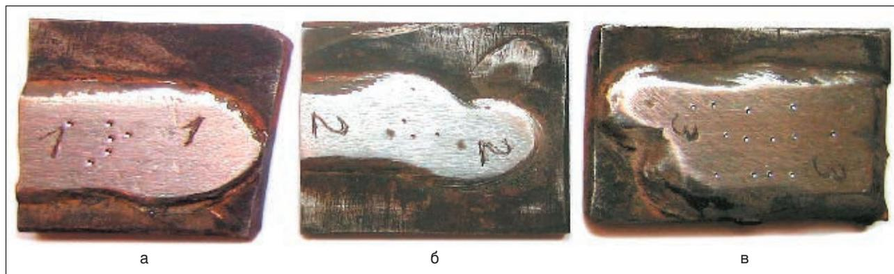
Рис. 5. Внешний вид образцов после испытаний на коррозионную стойкость: а — наплавленных сплошной проволокой Св–08Х20Н10Г7Т; б — опытной порошковой проволокой одиночными валиками; в — с перекрытием соседних валиков
