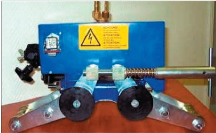
Рис. 2. Машина RSV-4 для резки труб
