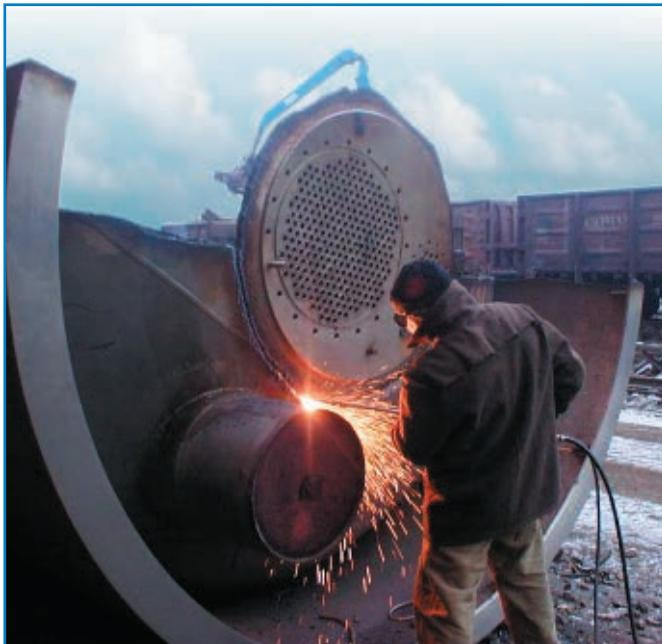
Специалисты завода «Донмет» быстро и качественно произведут разделку нержавеющей сталей до 180 мм, чугуна (станин, шаботов) до 1000 мм на мерные части в производственных условиях заказчика.
