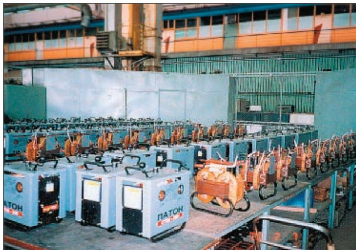
Рис. 1. Участок сборки трансформаторов СТШ–250 СГД на ОЗСО
