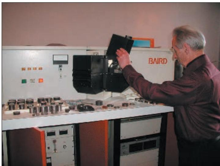
Рис. 6. Оптический эмиссионный спектрометр Spectrovac-1000 DV-4
