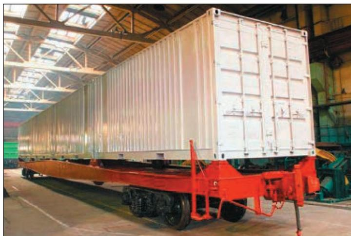
ходит через зоны с низкими климатическими температурами (до минус 60 °С). Поэтому для изготовления платформ используют термомеханически упрочненную низколегированную сталь X70 повышенной прочности.
