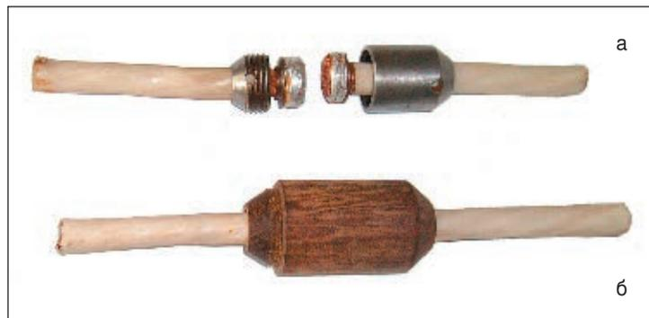
Рис. 2. Муфты, соединительные элементы которых изготовлены из стали (а) и изоляционного материала (б)
