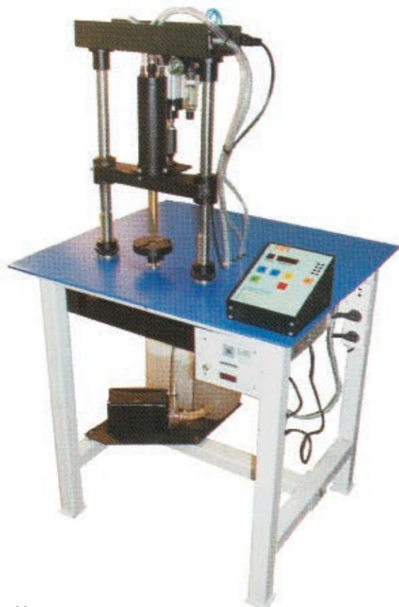
Ультразвуковая сварочная установка ИЛ100-7/2 для сварки термопластичных материалов
