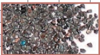
ют и не загрязняют обрабатываемую поверхность детали. Специальный состав и высокая упругость делают эти шарики очень твердыми, стойкими к ударам и, таким образом, малоизнашиваемыми.
