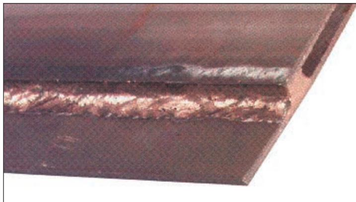
Рис. 7. Соединение, выполненное пайко-сваркой методом ColdArc стальных листов, оцинкованных гальваническим методом, щель между элементами 4 мм. Припой CuSi3 диаметром 1,0 мм
