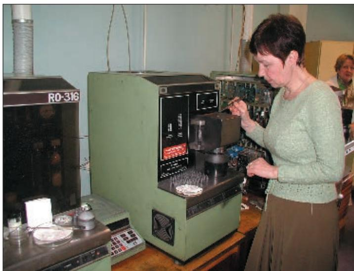
Рис. 4. Анализаторы газов RO-316, RH-2
