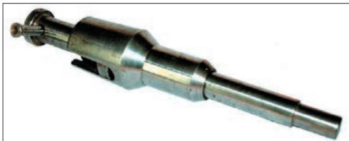
Рис. 5. Приспособление для неразъемного соединения кабелей с помощью гибкой оболочки
