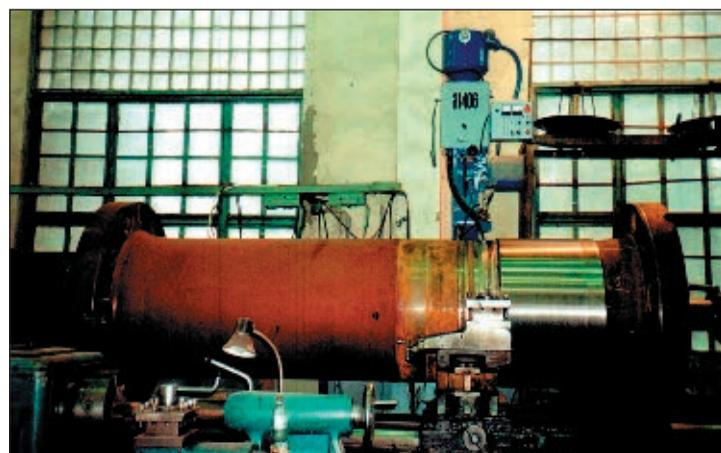
Рис. 2. Установка, выполненная на базе токарного станка РТ–166, для наплавки и последующей механической обработки валов гидротурбин
