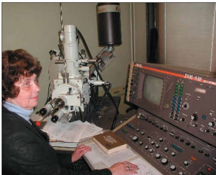
Рис. 3. Растровый электронный микроскоп JSM-840
