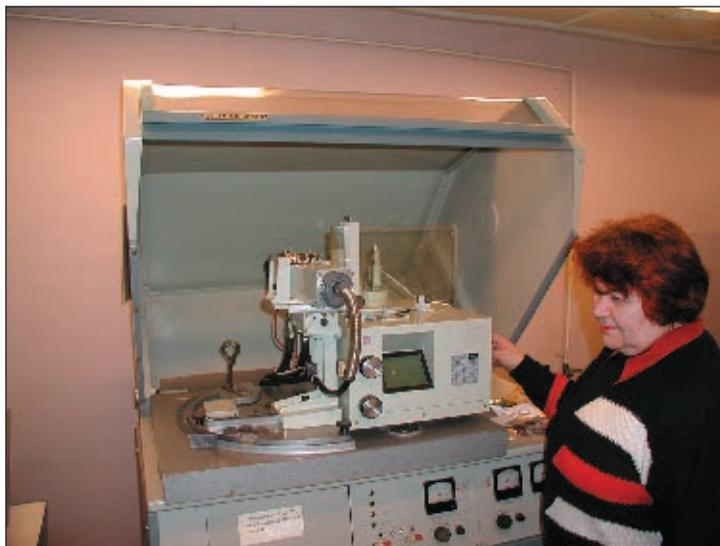
Рис. 7. Дифрактометр для рентгеноструктурного фазового анализа ДРОН-3, УМ-1
