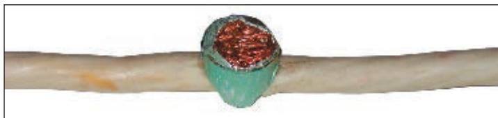
Рис. 4. Два кабеля, опрессованные совместно с гибкой оболочкой
