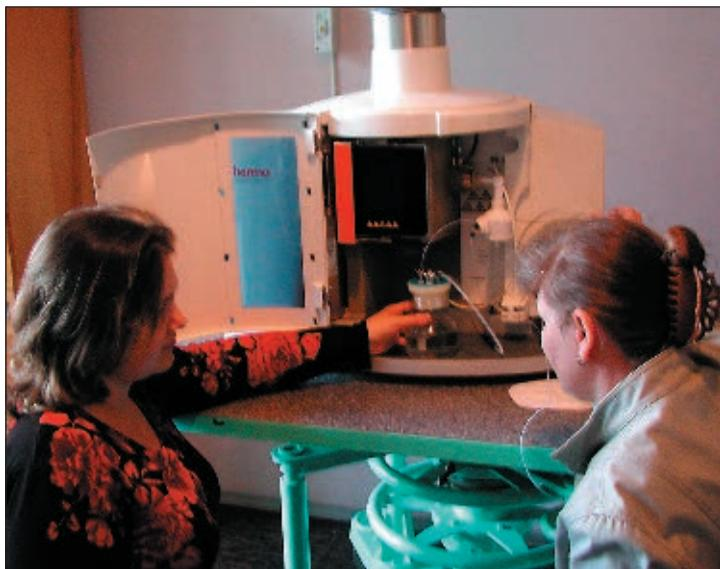
Рис. 5. ICP-спектрометр ICAP6500 DUO фирмы Thermo Fisher Scientific
