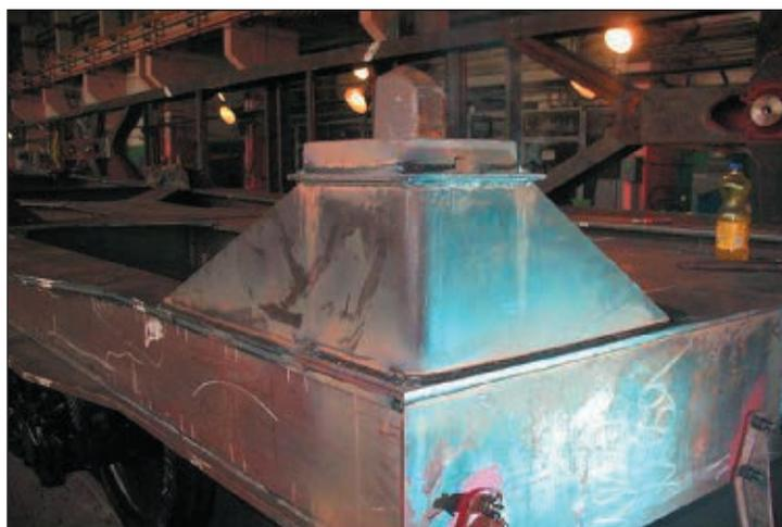
Рис. 3. Вид сваренной платформы со стороны узла угловой опоры
