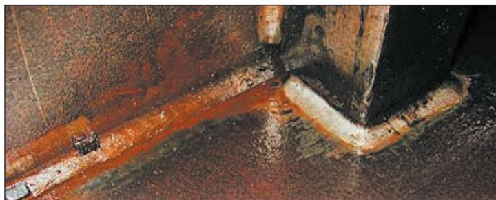
Рис. 4. Элементы сварного узла балки платформы после испытаний на усталостную прочность
